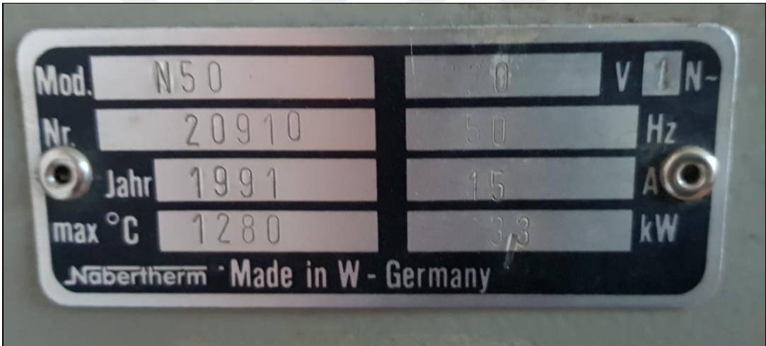
Şekil 31. Fırının marka ve azami çıkabileceği sıcaklığı gösteren bilgiler.
