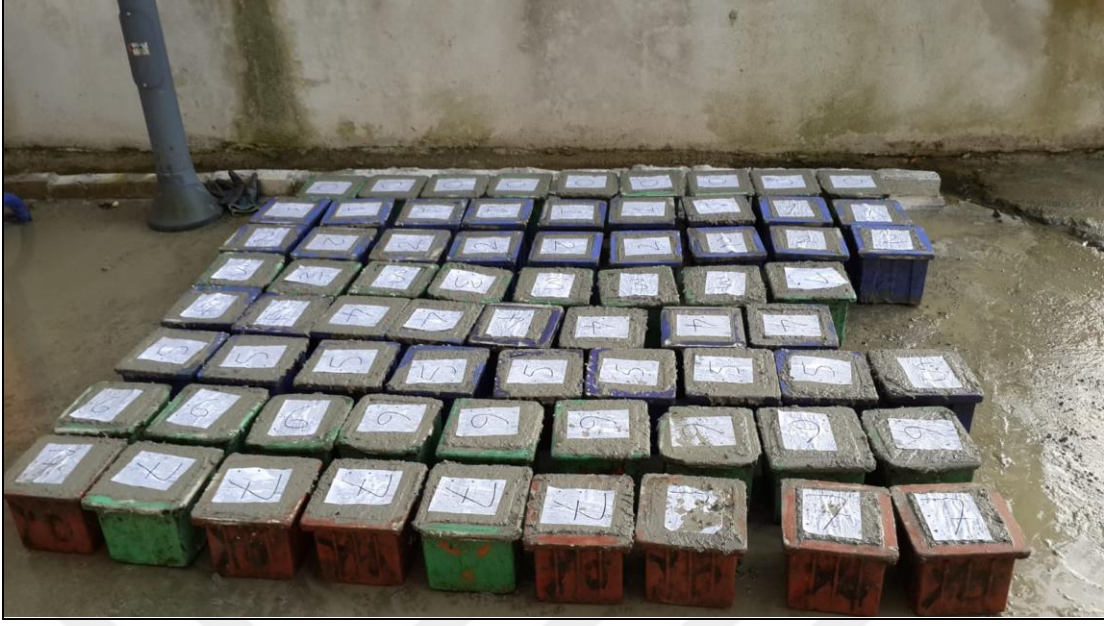
Şekil 36. Kalsine kolemanit küp numune örnekleri.
