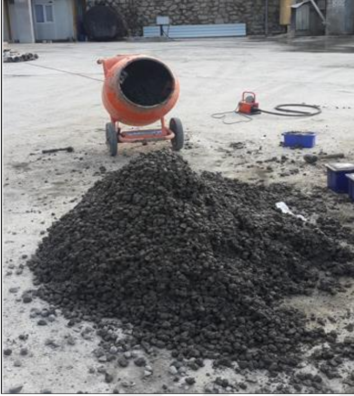
Şekil 33. Numunelerin hazırlanma aşamasında karıştırma kazanı ve numuneler için kullanılan vibratör.
