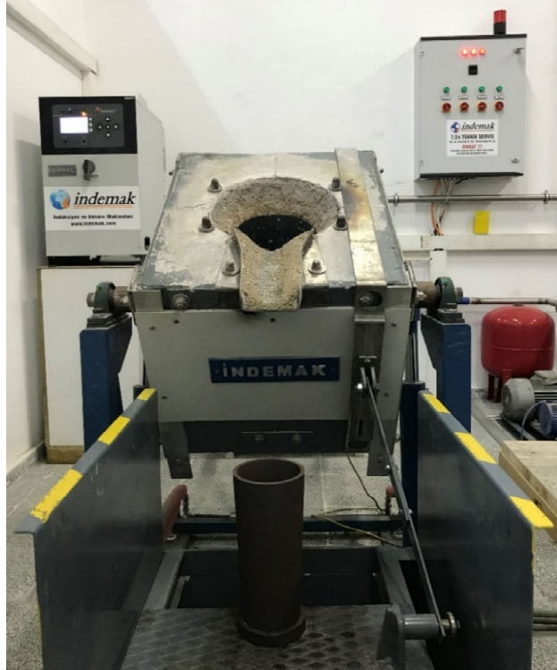
Şekil 11. Alaşımların üretiminde kullanılan indüksiyonlu ergitme ocağının fotoğrafı.
