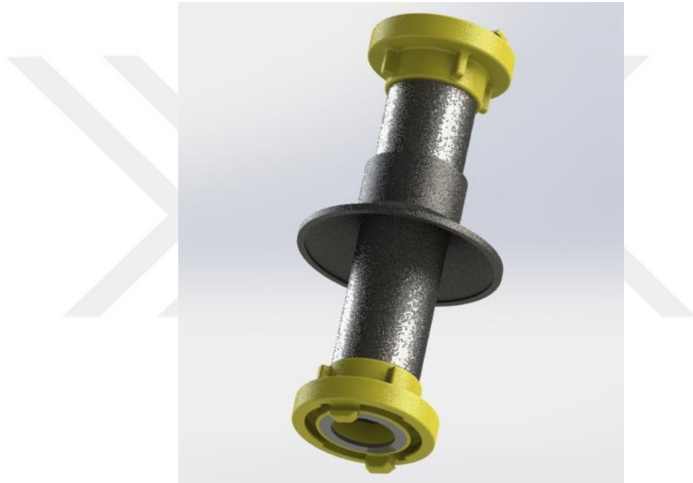
Şekil 7. Şemsiye tipi sıvı çıkış grubu tasarım görünümü.
