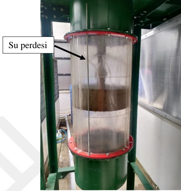
Şekil 27. Tek kademeli gaz temizleme ve partikül tutma ünitesine ait su perdesi görünümü.
