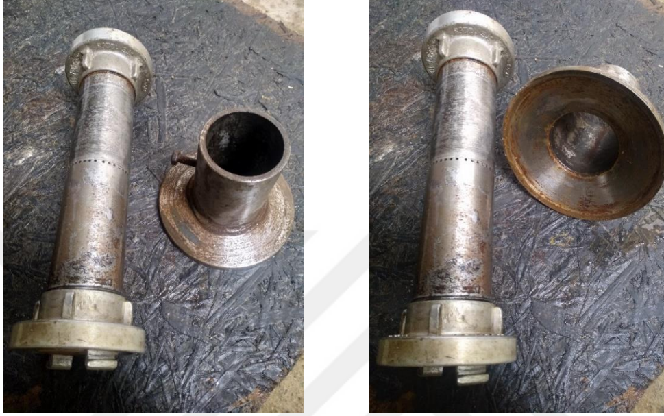
Şekil 24. Yıkama ünitesi şaft borusu ve şemsiyesi görünümü.
