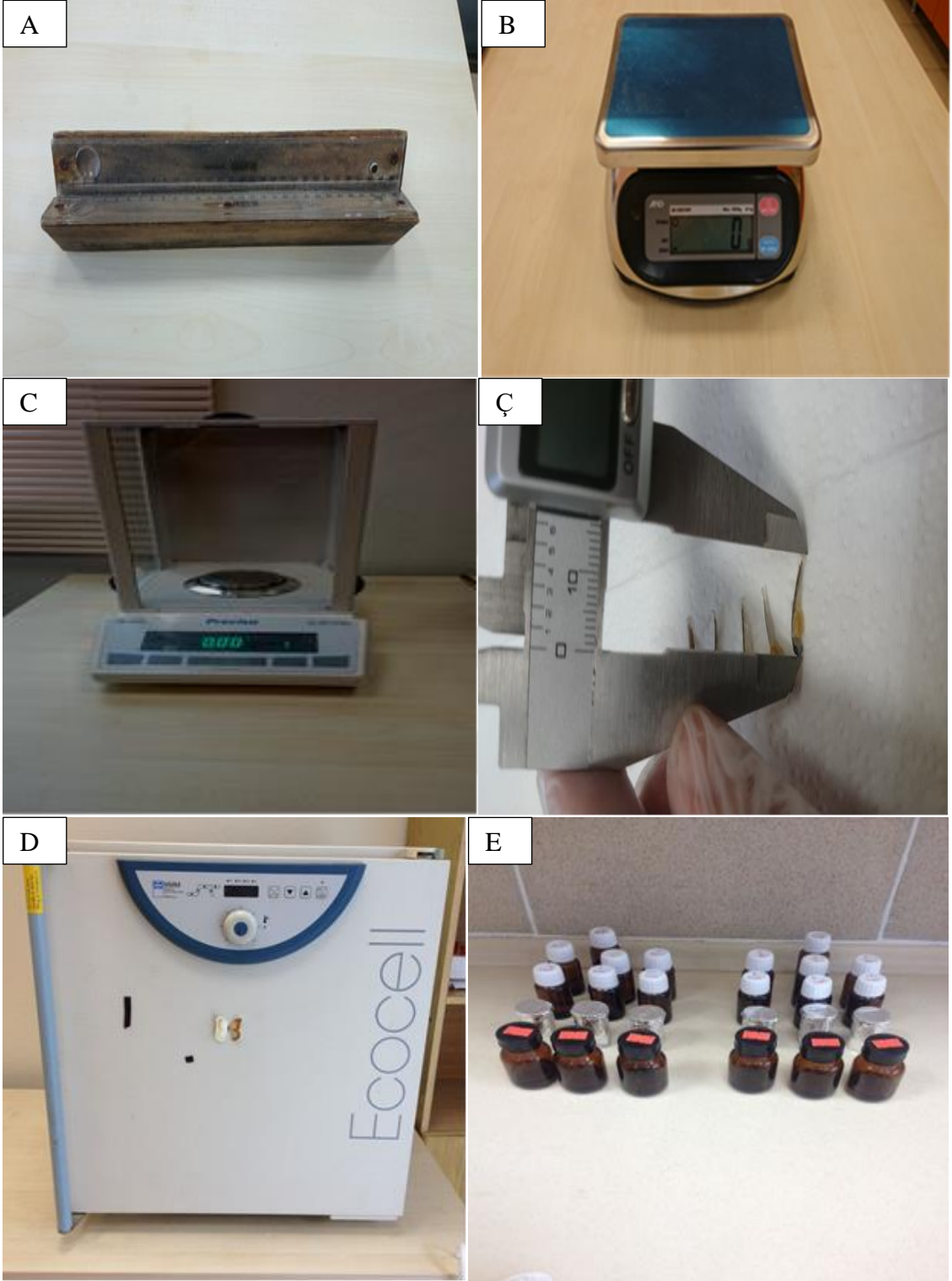
Şekil 6. Çalışmada kullanılan ekipmanlar (A: \pm 0,1 hassasiyetli ölçüm tahtası, B: \pm 1 hassasiyetli AND marka hassas terazi, C: \pm 0,0001 g hassasiyetli Presica marka terazi, Ç: Elektronik kumpas, D: Ecocell marka etüv, E: Renkli cam örnekleme şişeleri)
