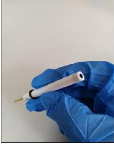
Şekil 12. (a) Karbon çalışma elektrodu (WE; çalışma elektrodu, r = 0,3\text{cm} A = 0,071\text{ cm}^2 ) (b) Tüm çalışma sistemi
