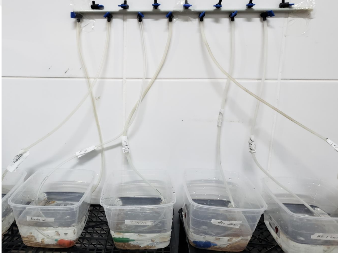
Şekil 3. Aeromonas hydrophila 'ya karşı bakterilerin baskılama deney düzeneği
