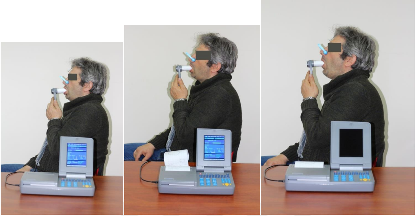
Şekil 14. Solunum fonksiyon testi düzeneği ve testin uygulanışı.
