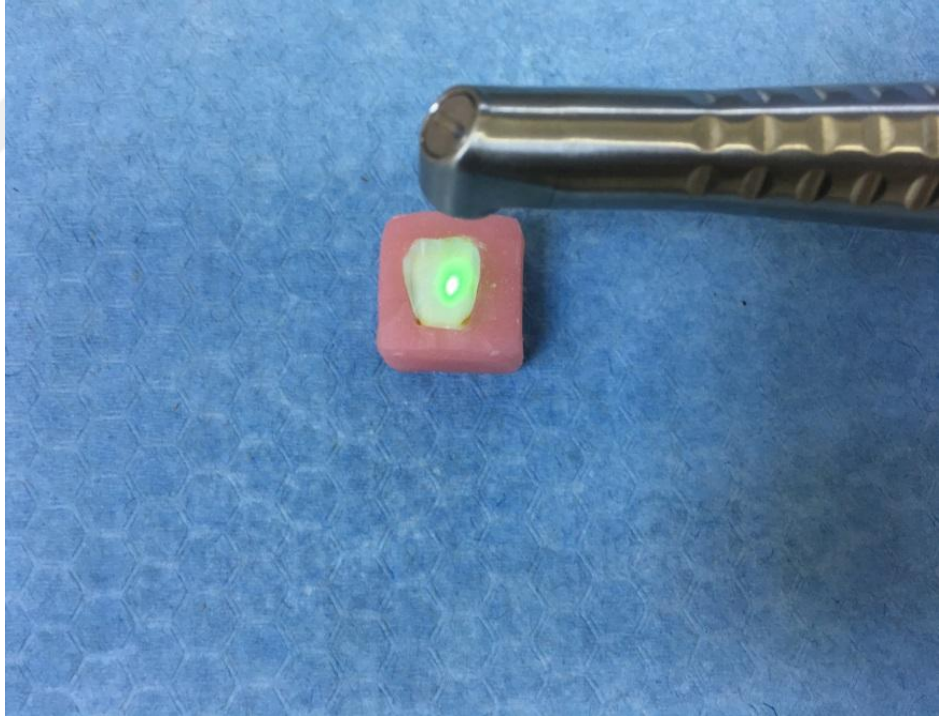
Şekil 3.10. Er:YAG lazerin dentin yüzeyine uygulanması
