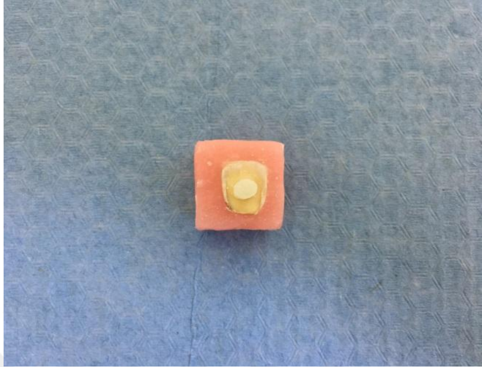
Şekil 3.4. Geçici restorasyon simante edilmiş örnek
