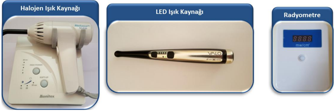
Şekil 3.2. Monitex Blue Luxer M-835 halojen ışık kaynağı, VALO Cordless marka LED ışık kaynağı, TREE markalı radyometre cihazı
