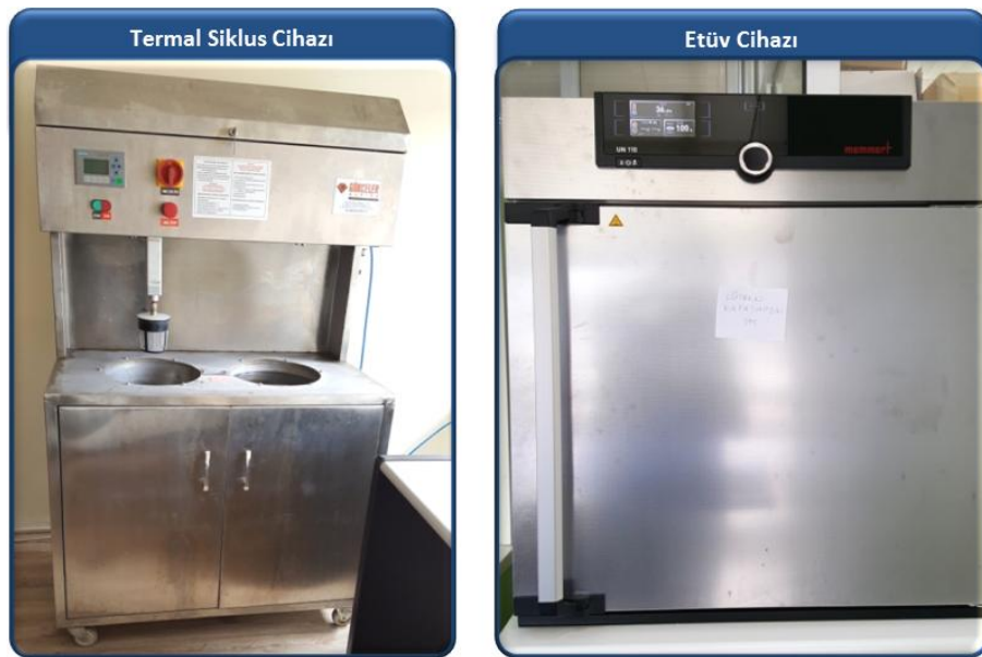
Şekil 3.5. Termal siklus cihazı, Memmert UN110 marka etüv cihazı
