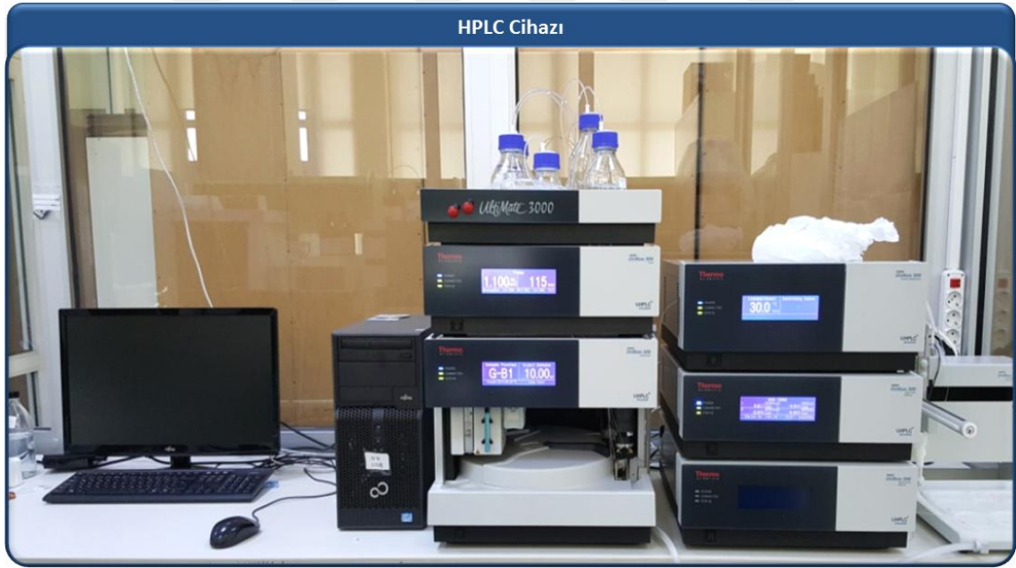
Şekil 3.6. Ultimate 3000 marka HPLC cihazı
