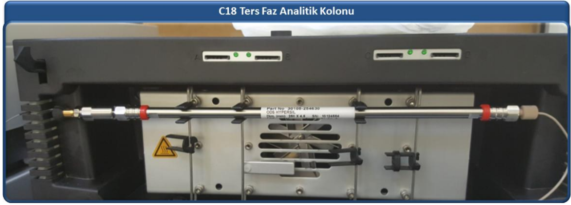
Şekil 3.7. Thermo ODS HYPERSIL marka C18 ters faz analitik kolonu
