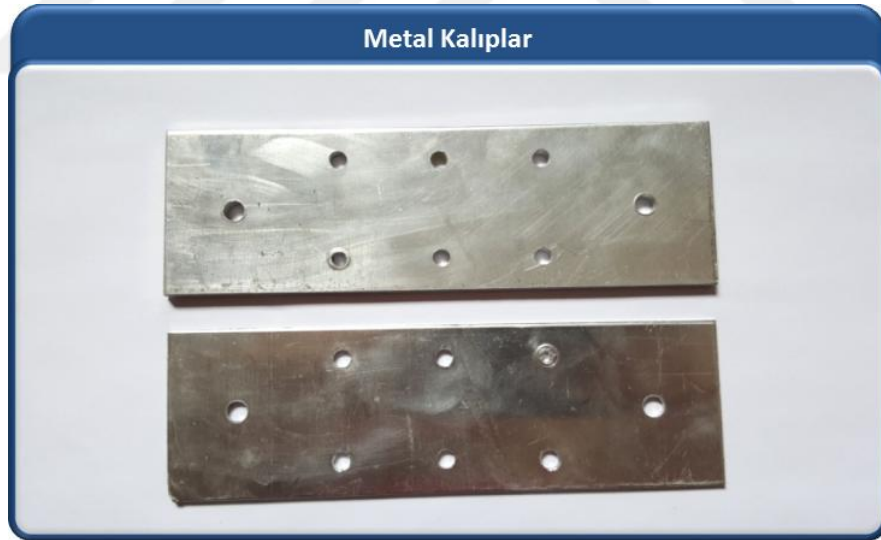
Şekil 3.3. Kompozit örneklerin oluşturulduğu metal kalıplar
