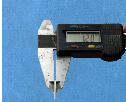
Şekil 3.6. Örnek kalınlıklarının dijital kumpasla ölçümü
