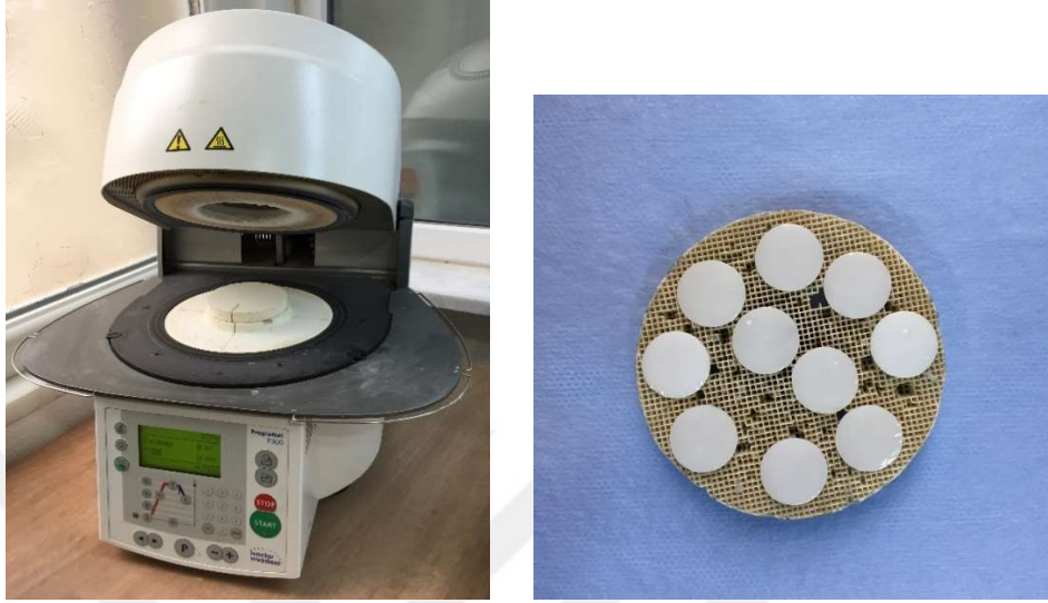
Şekil 3.7. Ivoclar Vivadent Programat P300 fırını
