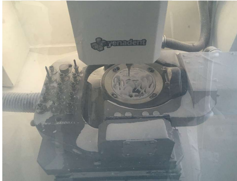
Şekil 3.4. Monolitik zirkonyum blokların kazınma işlemi
