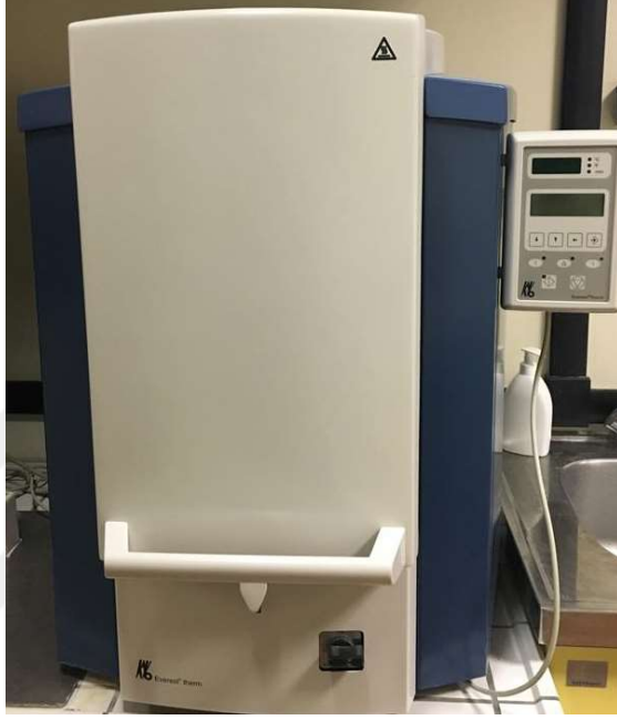
Şekil 3.5. KaVo Everest Therm sinterizasyon fırını
