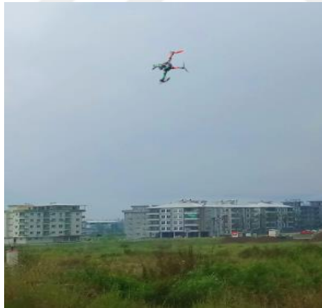
Şekil 46. Rüzgârlı Havada Yapılan Uçuşta Quadrotor'un Düşme Anı
