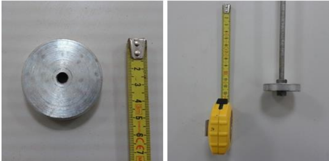
Şekil 3.17. Dairesel Ankraj Plakası ve Bağlantı Elemanı
