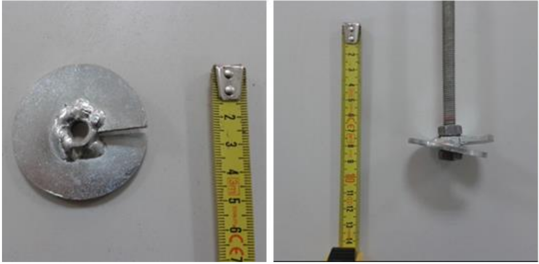
Şekil 3.16. Helisel Ankraj Plakası ve Bağlantı Elemanı
