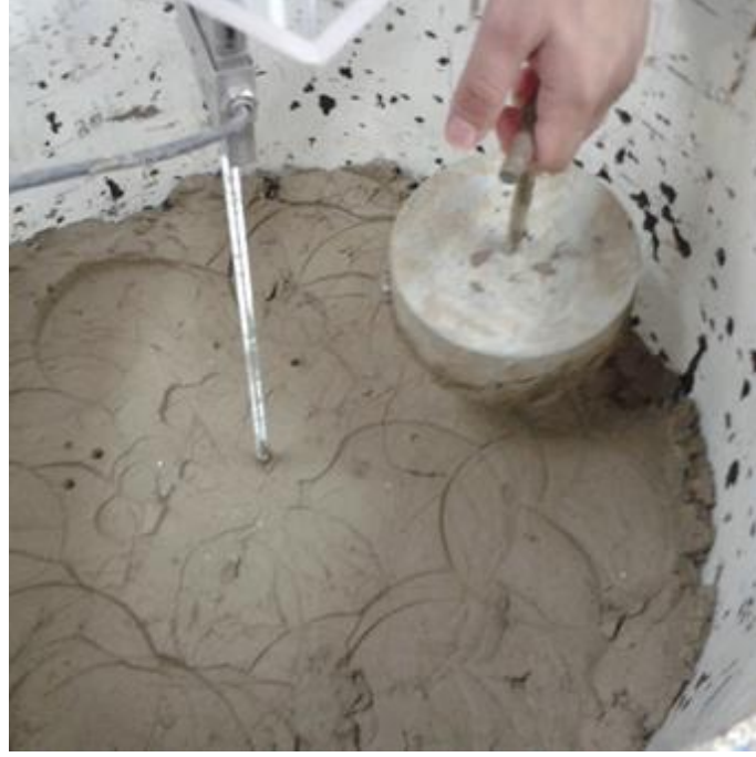
Şekil 3.24. Kil Zeminin Sıkıştırılması
