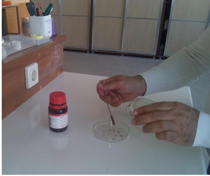
Şekil 3.6. LB-agar-nişasta besi ortamında gelişmiş izolatların iyot boyaması ile \alpha -amilaz fenotipik testi
