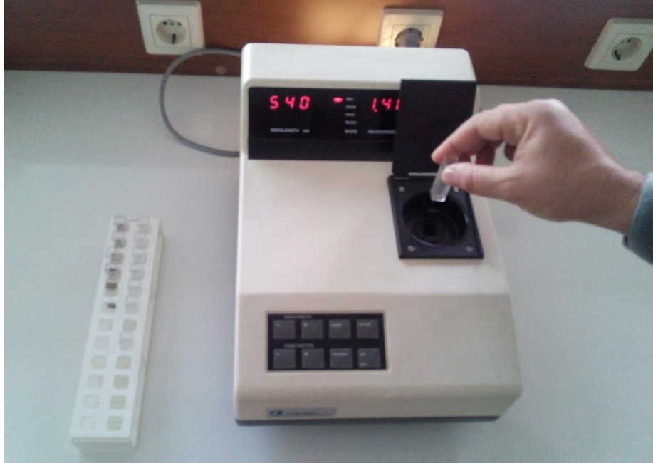
Şekil 3.6. Zamana göre bakteri kütle artışının spektrofotometrik olarak ölçümü
