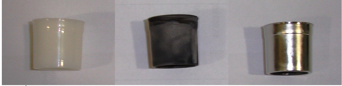
(a) İşlem görmemiş ABS (b) Pd-Sn çözeltisi ile Aktivasyon Akımsız Ni kaplama (c) Akımsız Ni kaplama üzerine önce asitli Cu daha sonra parlak Ni kaplama Şekil 5.2. \text{CrO}_3 + \text{H}_2\text{SO}_4 çözeltisi ile aşındırılmış ABS üzerine metal kaplama aşamaları
