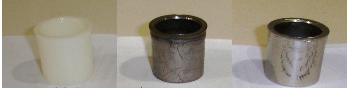
(a) İşlem görmemiş ABS (b) Ni/NaBH 4 çözeltisi ile aktivasyon (c) Asitli Cu kaplama daha sonra parlak Ni kaplama
