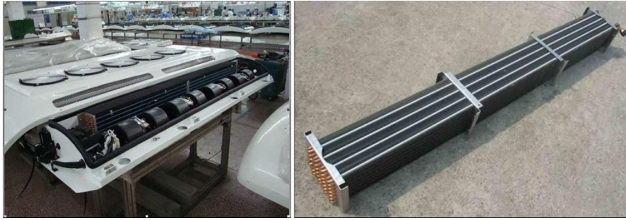
Şekil 3.10. Otobüs klimalarında kullanılan buharlařtırıcı örneđi
