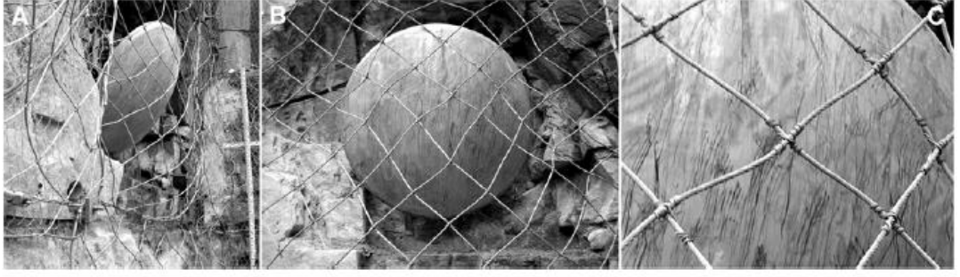
Şekil 2.7. Çelik ağ sistemi üzerinde yapılan arazi deneyleri [43]
