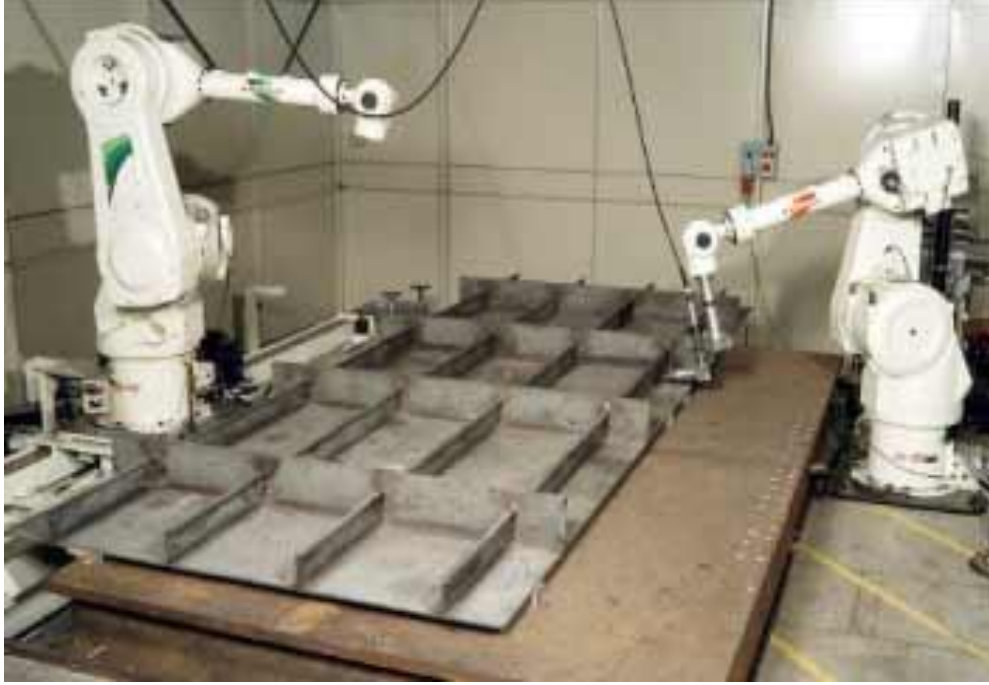
Şekil 2.1 GPE'nin İmalat Aşaması (www.twi-global.com)
