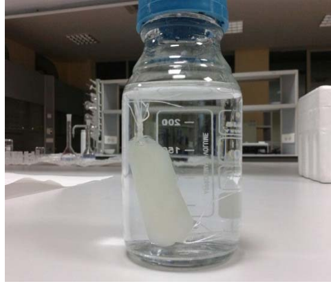
Şekil 3.6. Diyaliz kesesi içerisindeki örneğin uygun tampon içerisine alınması
