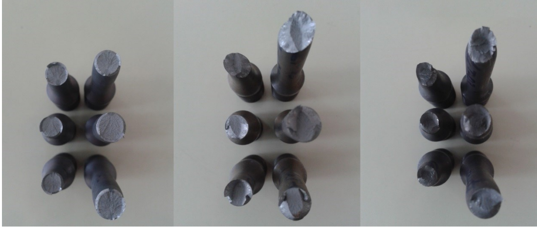
Şekil 4.2. Çekme numunelerinin kırılan yüzeyleri (Normalleştirme – sol, 200 °C’de menevişleme – orta, 400 °C’de menevişleme – sağ)
