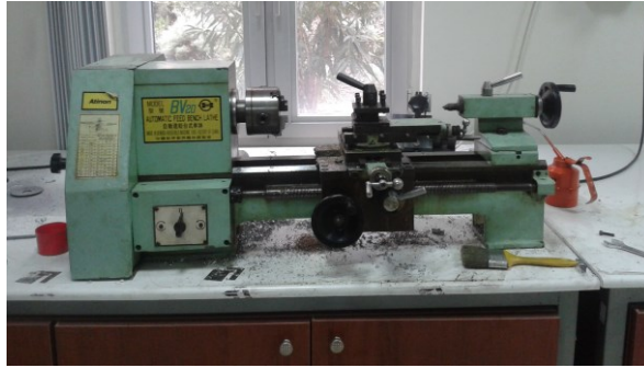
Şekil 3.6. V çentiklerin açıldığı Atinon BV20 marka torna tezgahı
