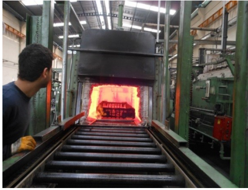
Şekil 3.12. Endotermik gaz (endogaz) ortam denetimli fırın [52]
