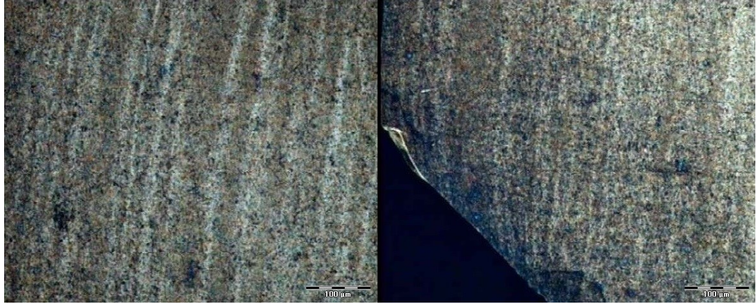
Şekil 4.11. 400 °C’de menevişlenmiş numunede delik etrafında ve yakınlarında dönüşmüş AKB oluşumları
