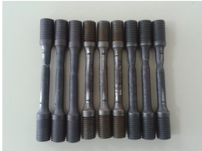
Şekil 4.1. Çekme testi sonucunda kırılan çekme numuneleri (Normalleştirme – sol, 200 °C’de menevişleme – orta, 400 °C’de menevişleme – sağ)
