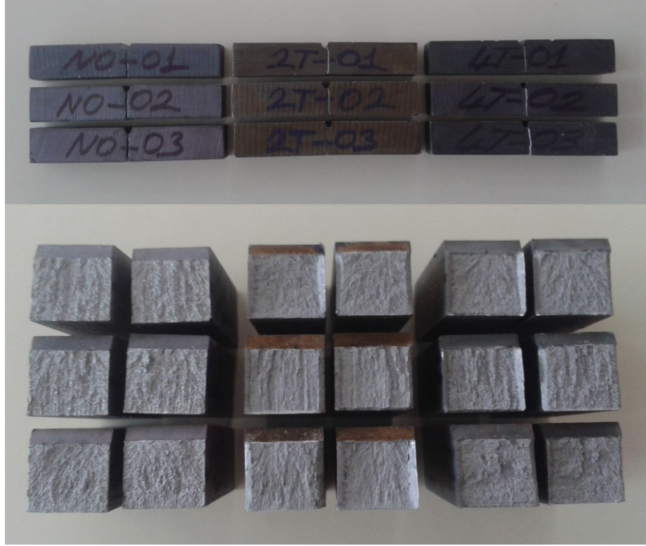
Şekil 4.4. Charpy çentik-darbe testi sonrası darbe numuneleri ve kırılan yüzeyleri (Normalleştirme – sol, 200 °C’de menevişleme – orta, 400 °C’de menevişleme – sağ)
