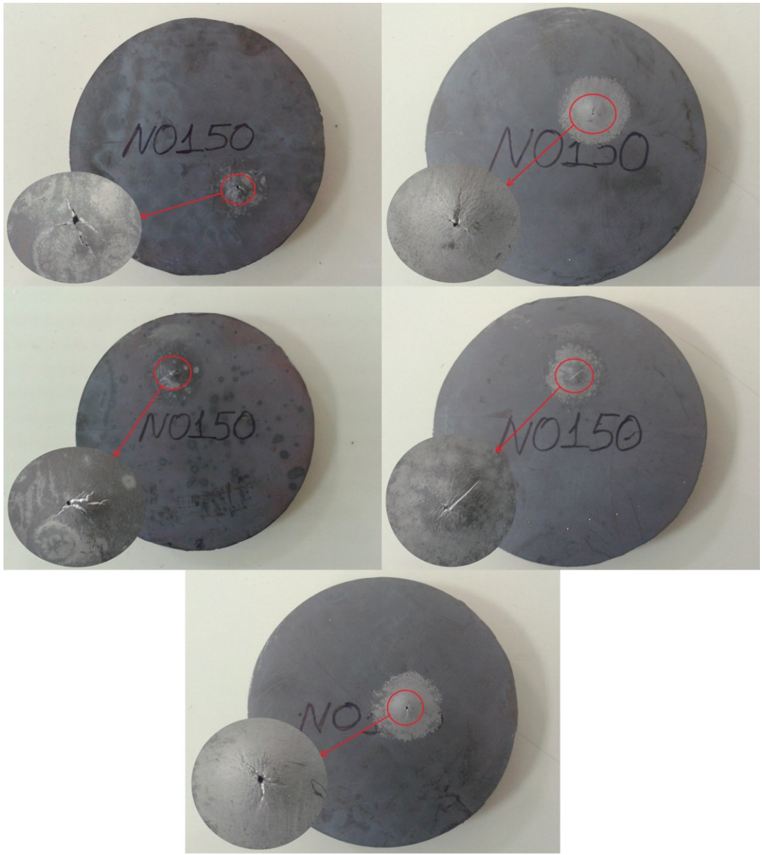
Şekil 4.22. NOS3 numunelerin arka yüzeyinde radyal çatlak oluşumu
