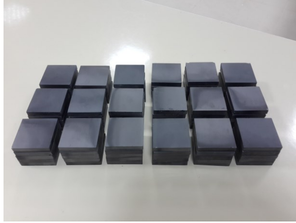
Şekil 3.7. SiC seramik plakalar (50x50x8,5 mm)
