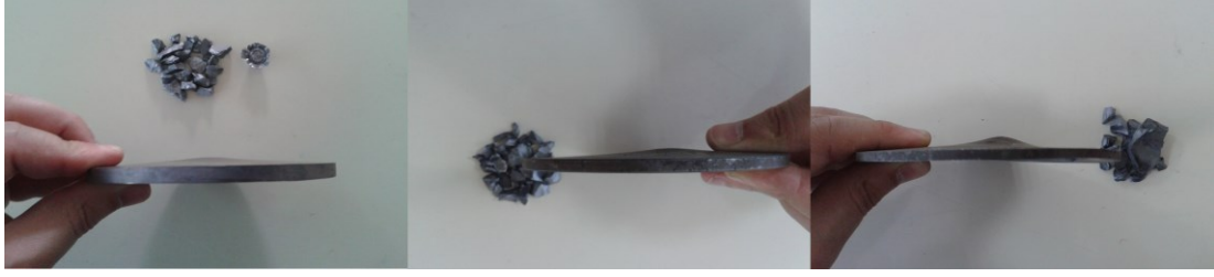
Şekil 4.32. Balistik test sonrası eğilen arka katman çelikleri (Normalleştirme 5,5 mm – sol, 200 °C’de menevişleme 4,5 mm – orta, 200 °C’de menevişleme 3,5 mm – sağ)
