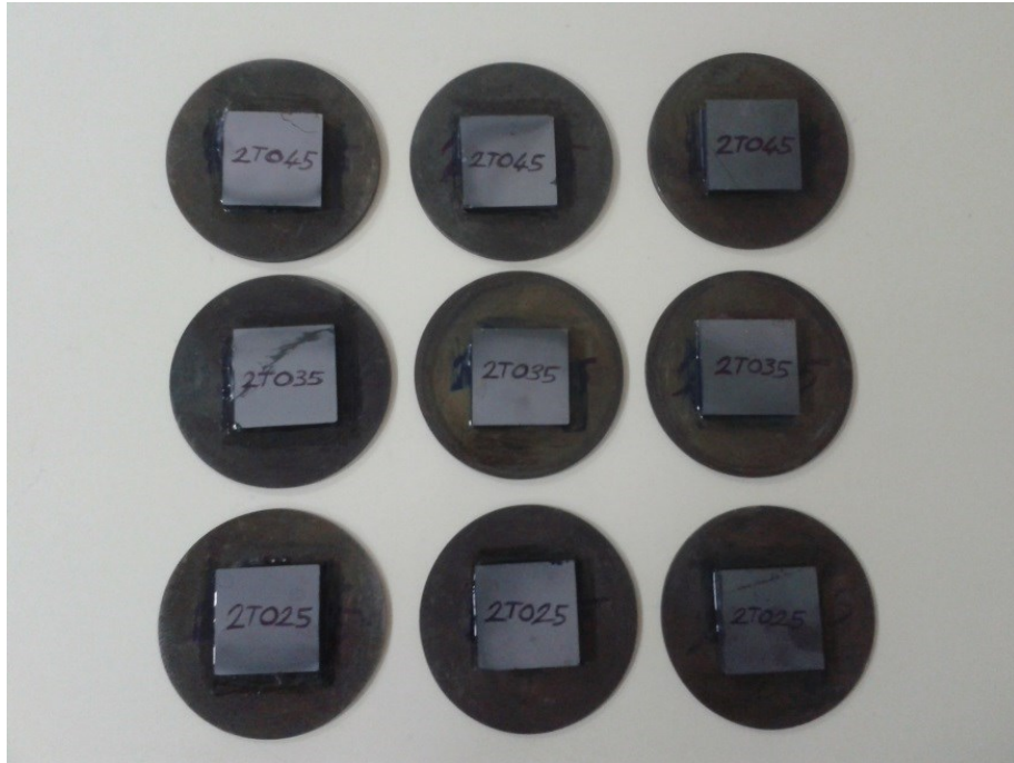
Şekil 3.10. İkinci balistik test için hazırlanan katmanlı kompozit numuneler
