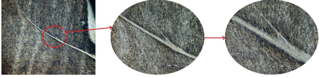
Şekil 4.10. 200 °C’de menevişlenmiş numunede delik etrafında tam dönüşmüş AKB oluşumu
