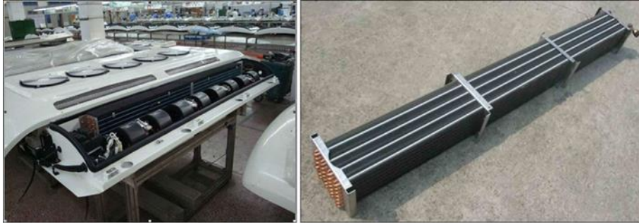
řekil 3.9. Otobüs klimalarında kullanılan buharlařtırıcı örneđi
