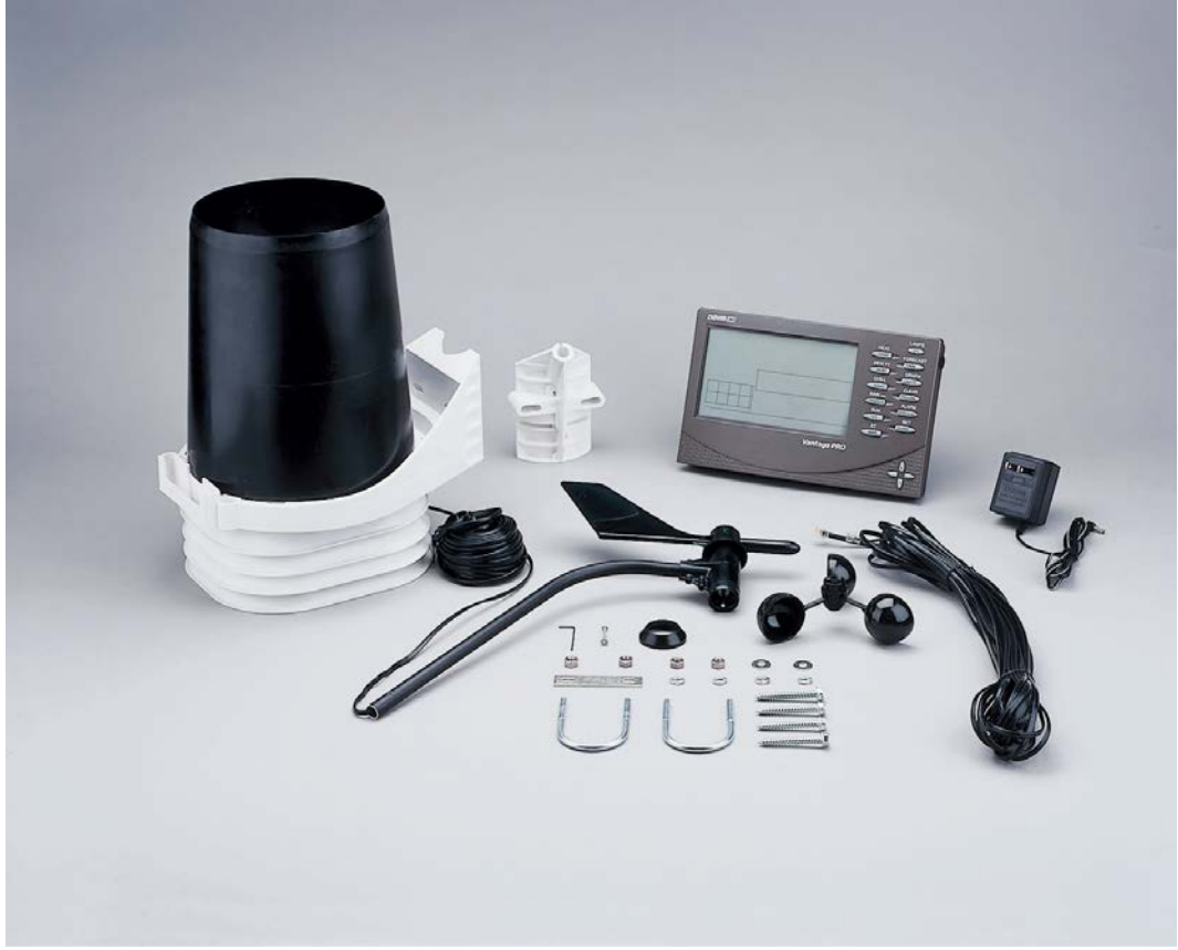
Şekil 3.5. Vantage Pro 2 meteorolojik ölçüm cihazı
