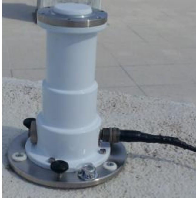
Şekil 3.21. Eppley tipi UV radyometre (Eppley Total Ultraviolet Radiometer: TUVR)
