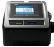
Şekil 3.2 Kyoto Yoğunlukölçer cihazı
