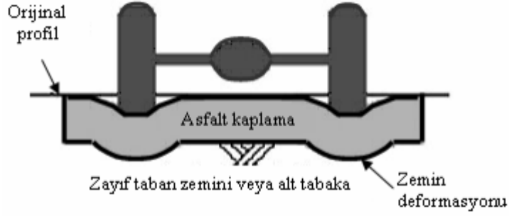
Şekil 2.2. Yapısal Tekerlek İzi (Kutluhan, 2008)
