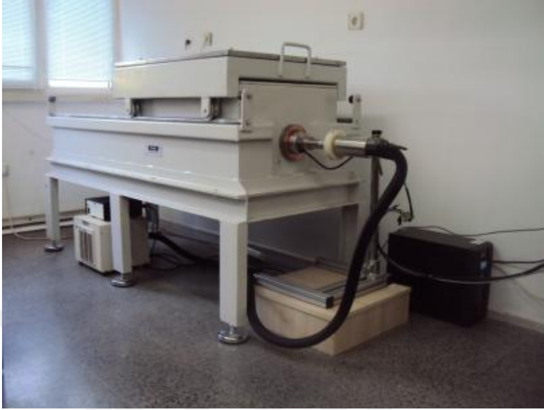
Şekil 3.2 Yüksek saflıkta germanyum (HPGe) dedektörü [22]
