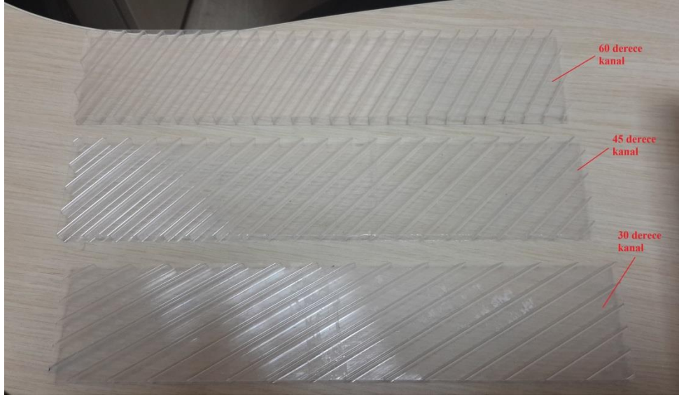
Şekil 3.13. 30, 45 ve 60° kanal açılı 60x300x10 mm'lik levhalar
