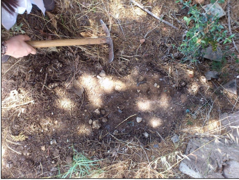
Şekil 3.11. Toprak örneği alınırken oluşturulan çerçeve modeli (25x25 cm 2 )
