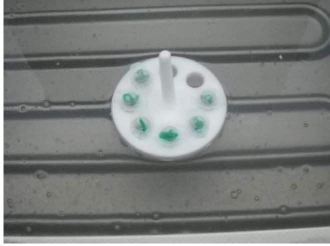
Şekil 3.3. Toprak numunelerinde bulunan vejetatif bakterilerin pastörizasyonu
