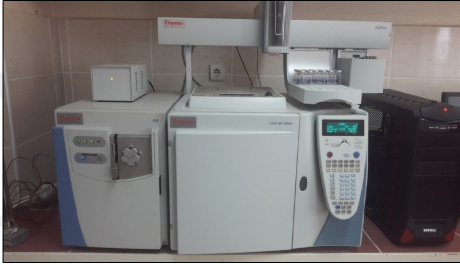
Şekil 3.11. Uçucu yağda 1,8 cineol içeriğini ölçen kütle spektrometresi
