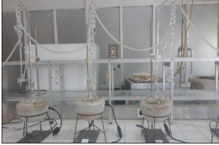
Şekil 3.7. Uçucu yağ eldesinde kullanılan Clevenger cihazı
