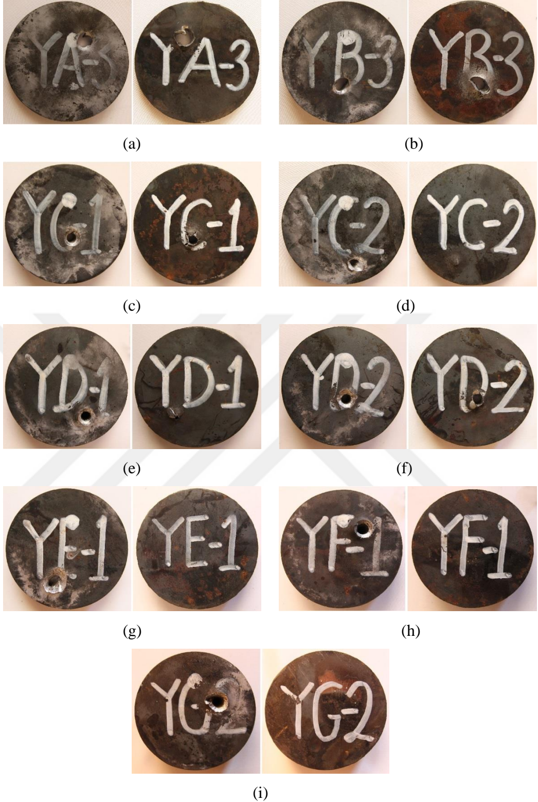
Şekil 5.19. Östemperlenme uygulanan yalın çeliklerin balistik atış sonrasında ön (sol) ve arka (sağ) görüntüleri a) 47 kg/m 2 , b) 62,7 kg/m 2 , c) 78,4 kg/m 2 delinen, d) 78,4 kg/m 2 delinmeyen, e) 94,1 kg/m 2 delinmeyen, f) 94,1 kg/m 2 delinen, g) 109,8 kg/m 2 , h) 125,4 kg/m 2 ve i) 141,1 kg/m 2
