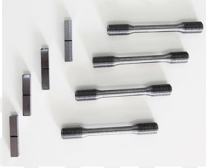
Şekil 4.2. Hazırlanan çekme ve darbe numuneleri
