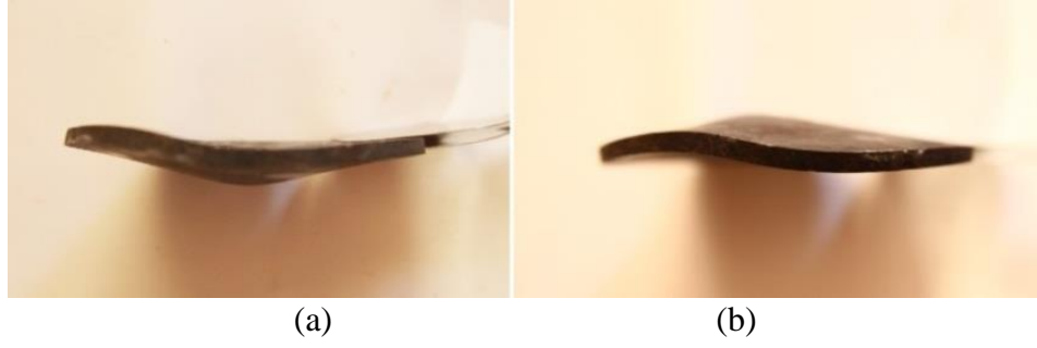
Şekil 5.26. Balistik test ardından arka katman çeliklerinde görülen eğilme a) AB-2 numunesi b) AB-3 numunesi
