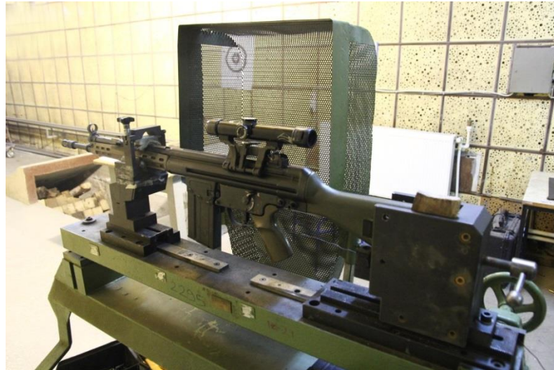
Şekil 4.22. Deneylerde kullanılan G3 piyade tüfeği
