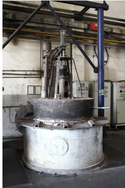
Şekil 4.10. Ortam denetimli kuyu tipi fırın
