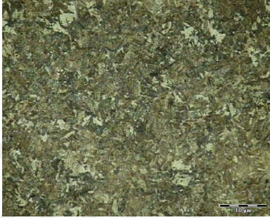
Şekil 5.5. Balistik test öncesi numunelerin x500 büyütmede içyapı görüntüsü
