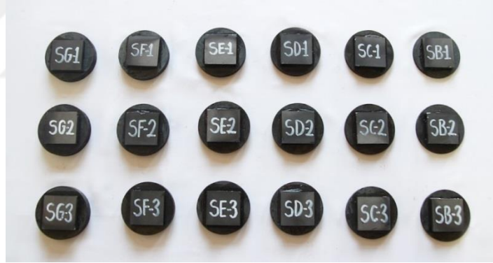
Şekil 4.7. SiC ön katmanlı kompozit numuneler
