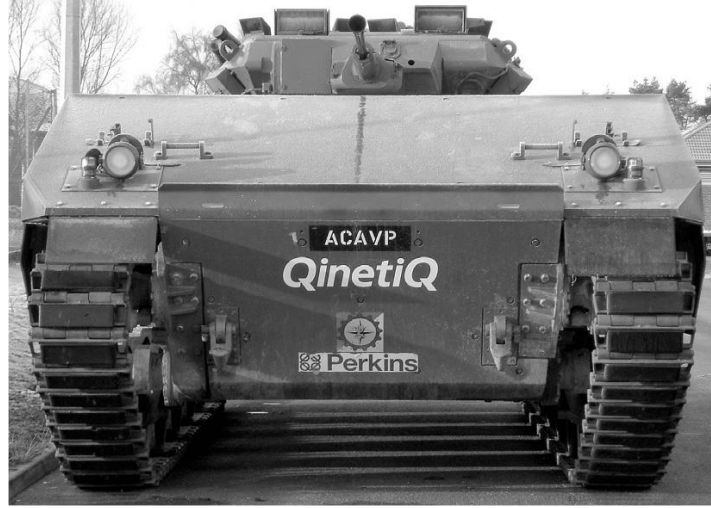
Şekil 3.12. Zırhında cam elyaf takviyeli polimer esaslı kompozit kullanılmış olan bir zırhlı araç (Hazell, 2016)
