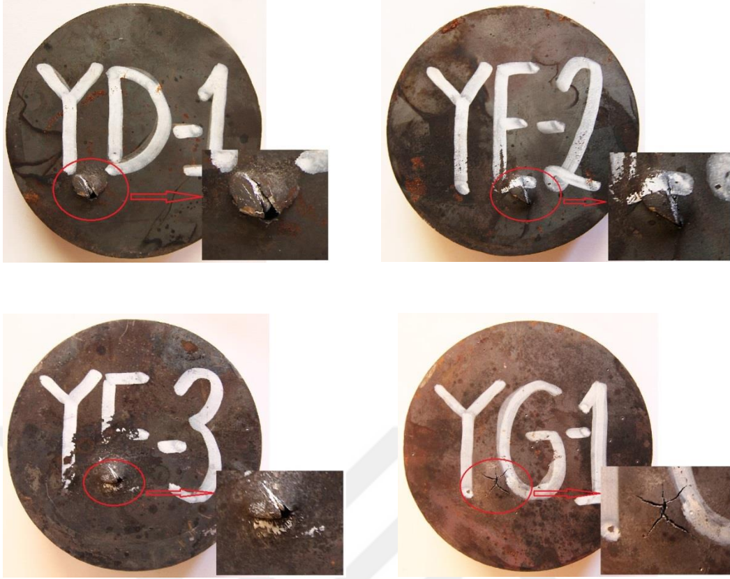
Şekil 5.20. Arka yüzünde radyal çatlak oluşan numunelerin görüntüleri
