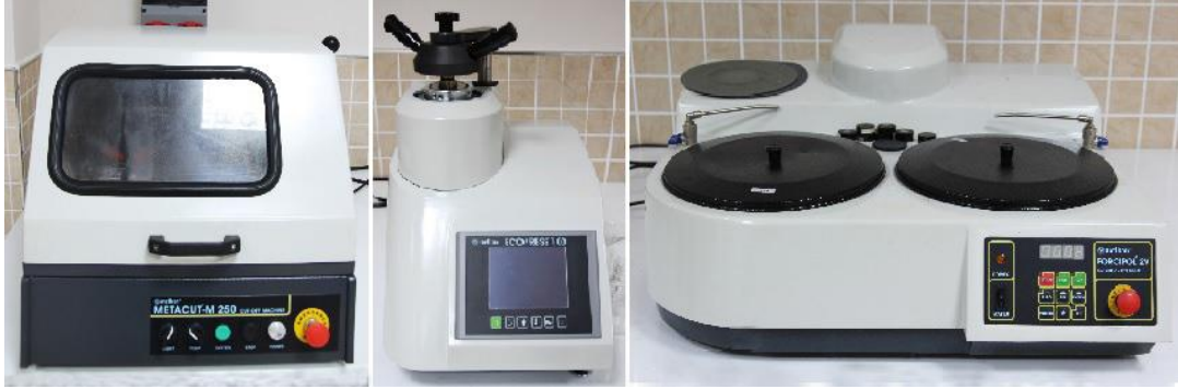
Şekil 4.14. Kesme cihazı Metcon Metacut-M 250 (sol), bakalite alma cihazı Metcon Ecopress 100 (orta), zımpara ve parlatma cihazı Metcon Forcipol 2V (sağ)
