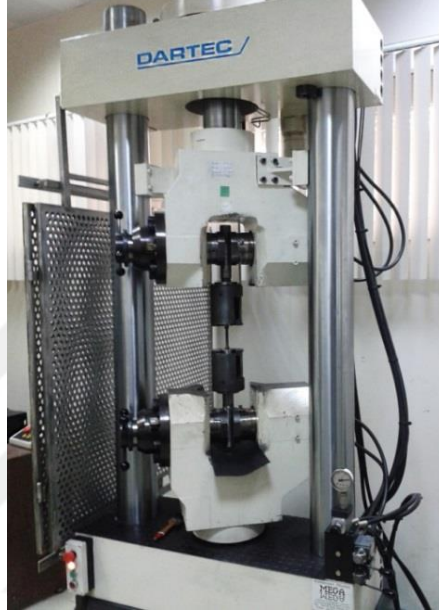
Şekil 4.19. DARTEC-MTS marka çekme cihazı
