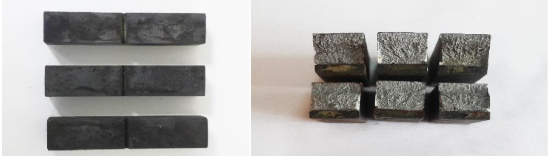
Şekil 5.4. Charpy çentik-darbe numuneleri ve deney sonrasında kırılan yüzeyleri
