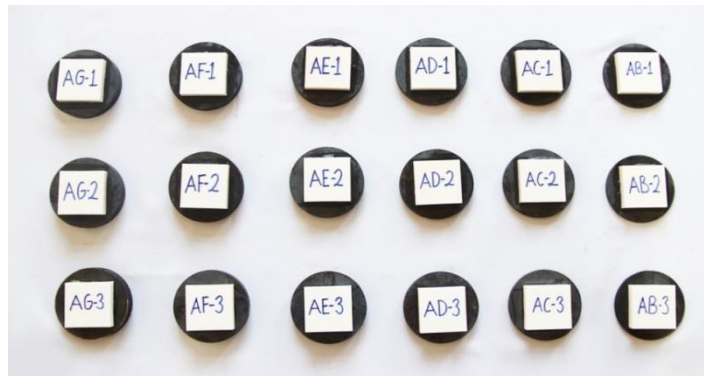
Şekil 4.8. \text{Al}_2\text{O}_3 ön katmanlı kompozit numuneler
