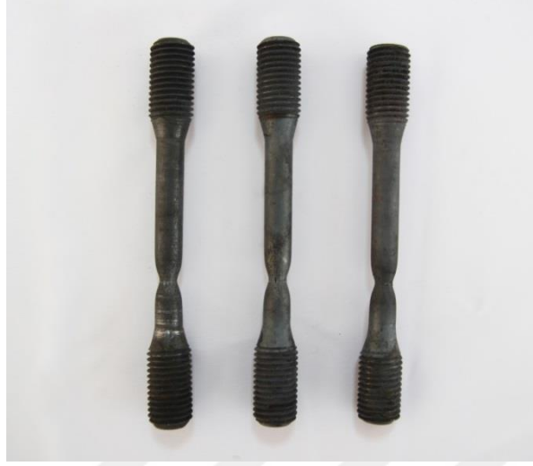
Őekil 5.1. Őekme deneyi sonucunda kırılan Őekme numuneleri
