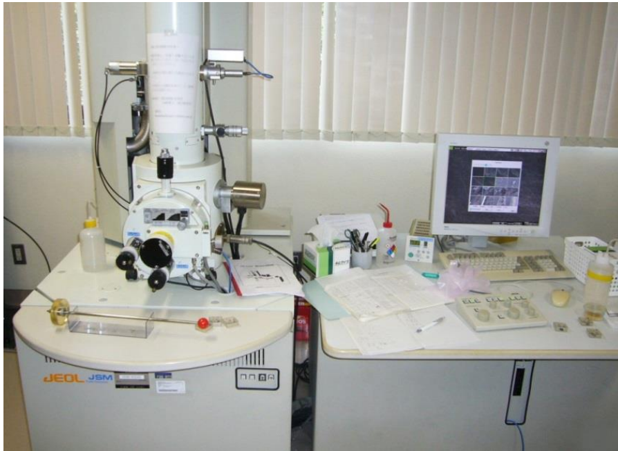
Şekil 4.15. JEOL/JSM-6335F marka taramalı elektron mikroskobu
