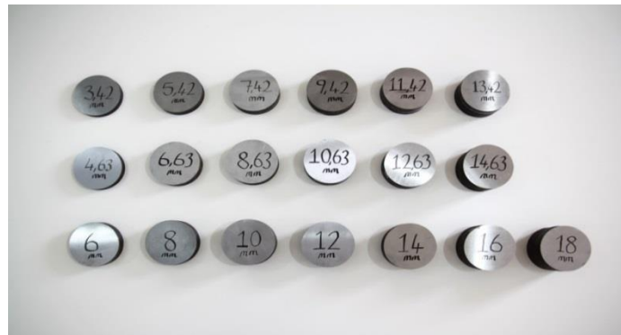
Şekil 4.1. AISI 4140 çelik numuneler
