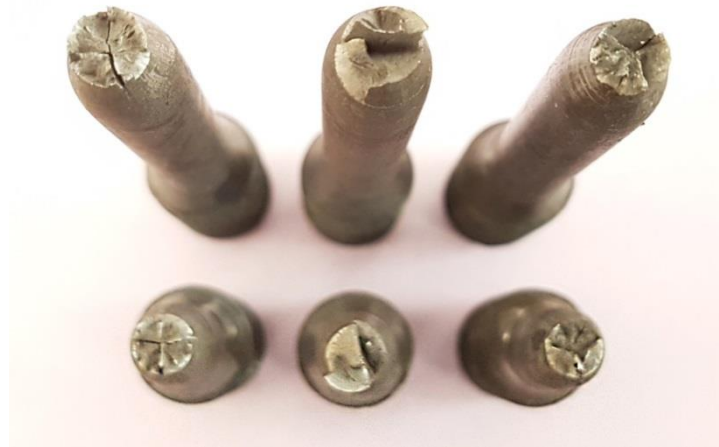
Őekil 5.2. Őekme numunelerinin kırılan yzeyleri
