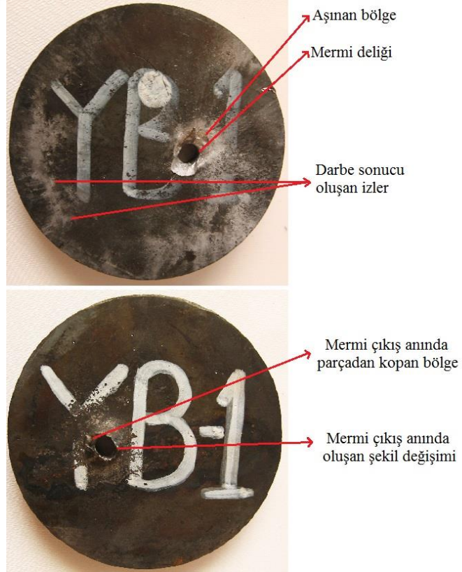
Şekil 5.21. 62,7 kg/m 2 alan yoğunluğuna sahip numunenin atış sonrası görüntüsü
