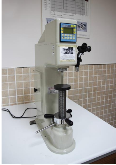
Şekil 4.21. BMS DIGIROCK-RBOV marka sertlik ölçüm cihazı
