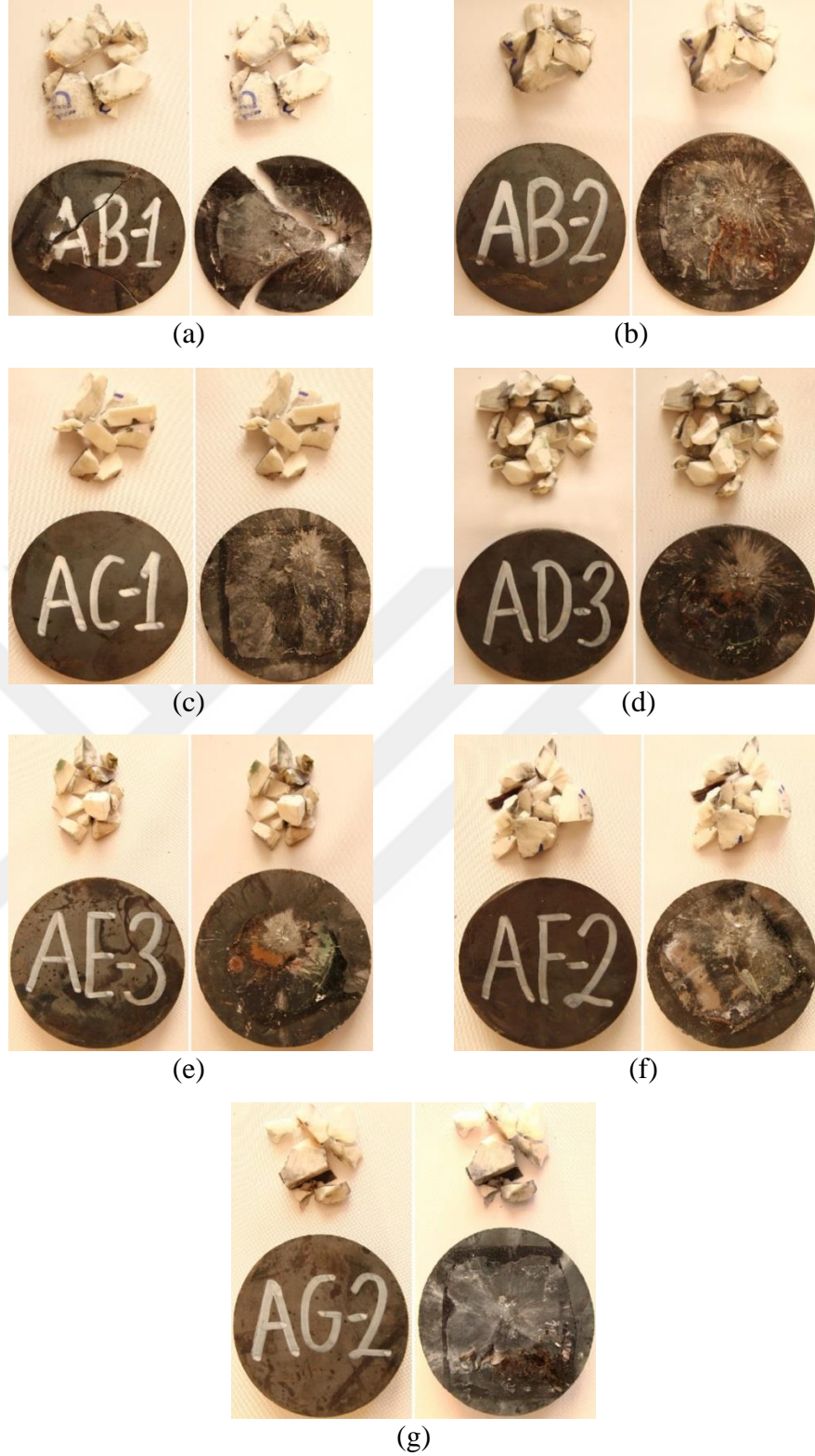
Şekil 5.25. Ön katmanında Al_2O_3 , arka katmanında östemperlenmiş AISI 4140 çeliği bulunan kompozit numunelerin balistik atış sonrası görüntüleri a) 62,7 \text{ kg/m}^2 parçalanmış numune, b) 62,7 \text{ kg/m}^2 , c) 78,4 \text{ kg/m}^2 , d) 94,1 \text{ kg/m}^2 e) 109,8 \text{ kg/m}^2 , f) 125,4 \text{ kg/m}^2 , g) 141,1 \text{ kg/m}^2
