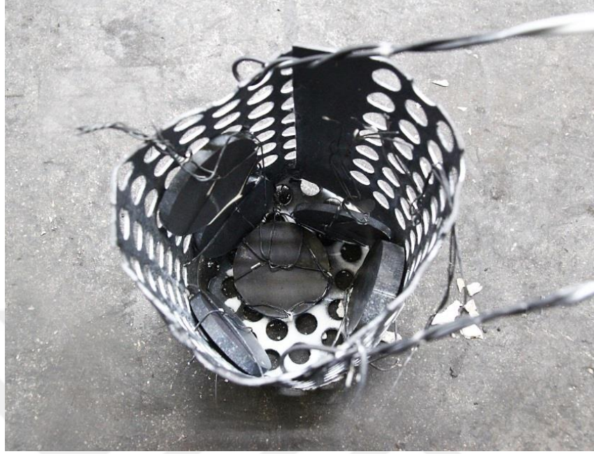
Şekil 4.12. Östemperlenme işlemi tamamlanmış AISI 4140 çeliğinden plakalar
