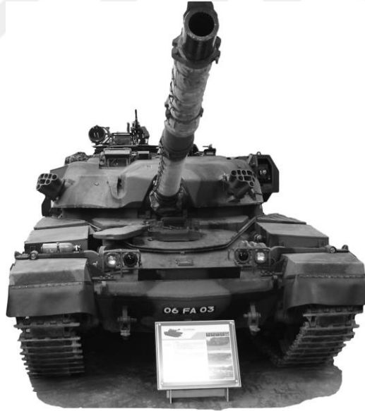
Şekil 3.6. Döner taretli döküm zırhtan üretilmiş olan Chieftain AMT (Hazell, 2016)
