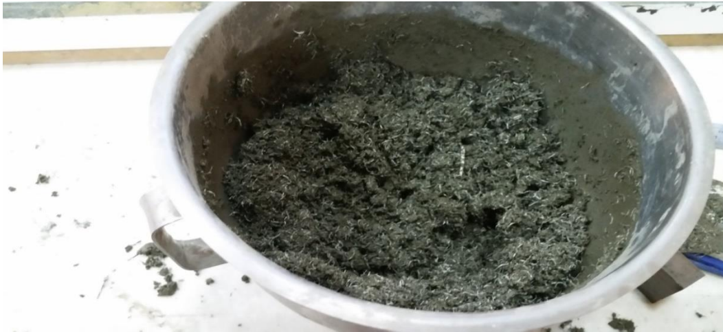
Şekil 3.16. Beyaz lifli (Polipropilen (PP)) PVC atık malzemesinin harçla karıştırılmış hali
