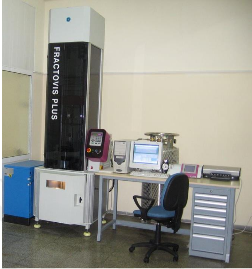
Şekil 4.6 Instron Dynatup dikey ağırlık düşürmeli darbe test cihazı.
