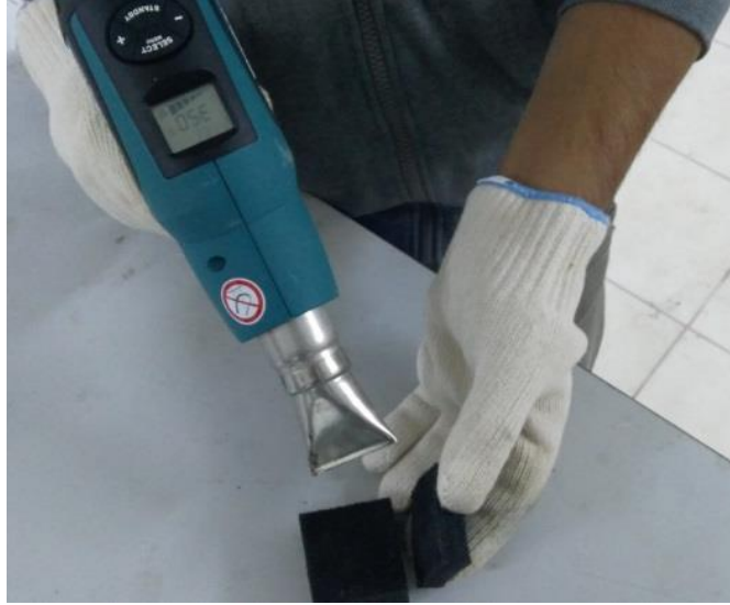
Şekil 4.2 Sıcak yapıştırma ile katmanlı köpük hazırlanması.
