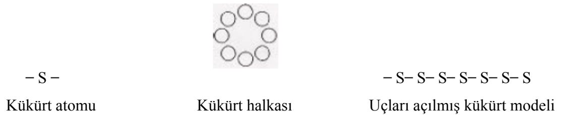
Şekil 1.15. Kükürt atomu, kükürt halkası ve uçları açık kükürt molekülü [1]
