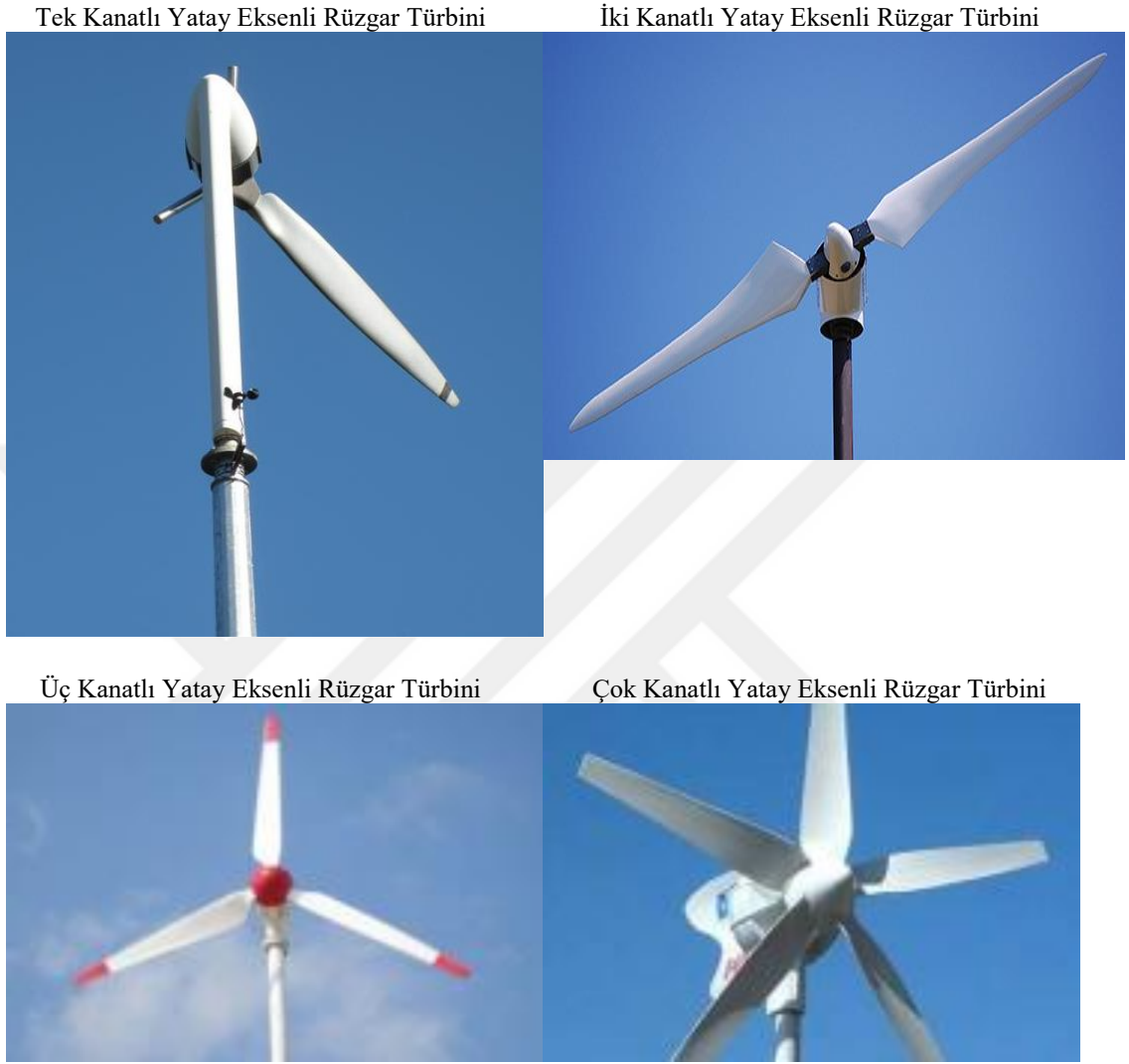
Şekil 4.2 Kanat Sayılarına Göre Yatay Eksenli Rüzgar Türbinleri [51], [53], [54]
