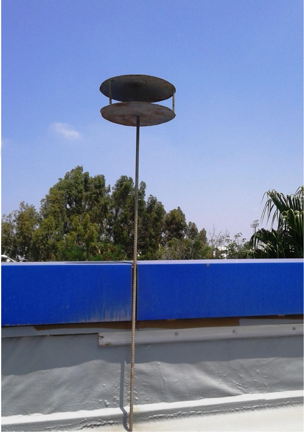
Şekil 3.2 Durham Aracının yerleştirildiği istasyon: b) Çatı (10 metre)
