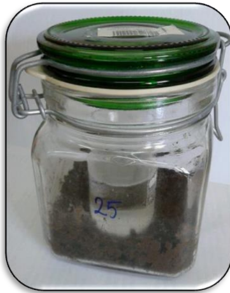
Şekil 3.7. Örnek bir karbon mineralizasyon kavanozu
