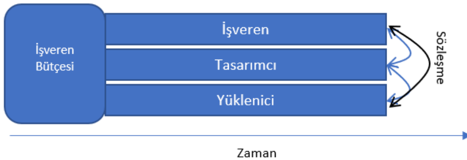
Şekil 3.21. Entegre Proje teslim yöntemi uygulama şeması
