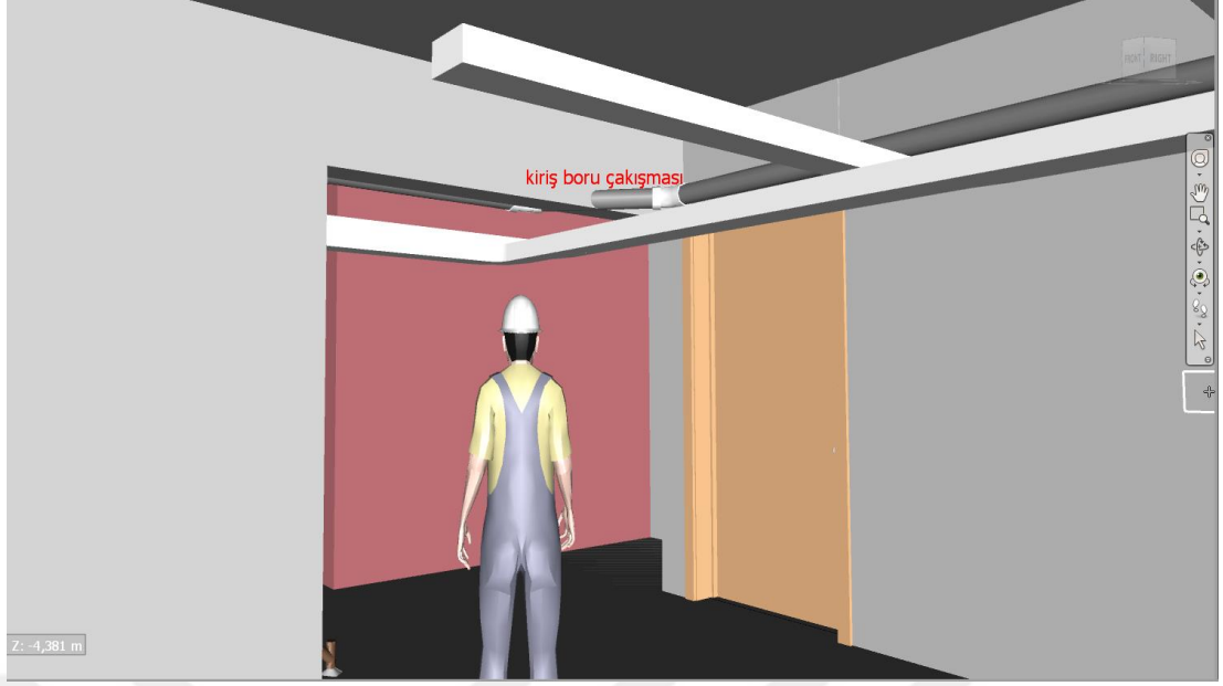
Şekil.6.14. Çakışma analizi sonucu görülen çakışmanın animasyon gösterimi-2
