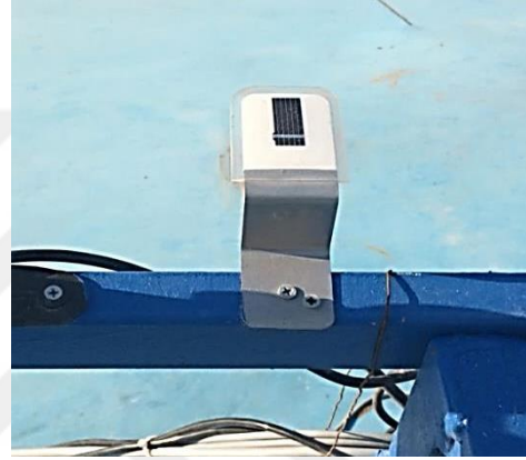
Şekil 3.21. Ölçümlerde kullanılan ışıınım ölçer [33]
