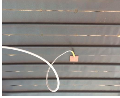
Şekil 3.20. Ölçümlerde kullanılan yüzey sıcaklık ölçer [33]
