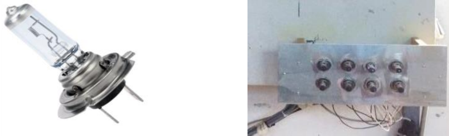
Şekil 3.24. Ölçümlerde akım ölçmek için kullanılan ampüller [34]
