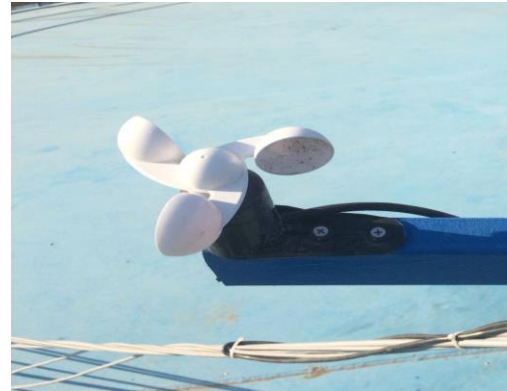
Şekil 3.22. Ölçümlerde kullanılan rüzgar hızı ölçer [33]
