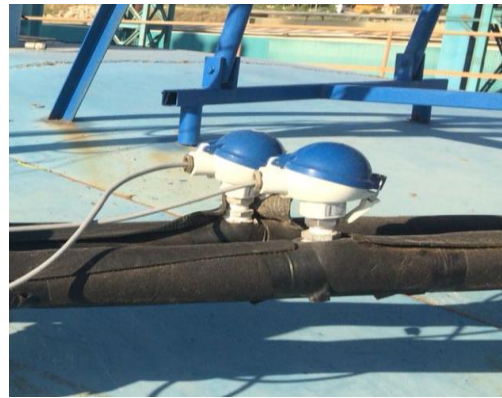
Şekil 3.19. Ölçümlerde kullanılan su sıcaklık ölçer [32]
