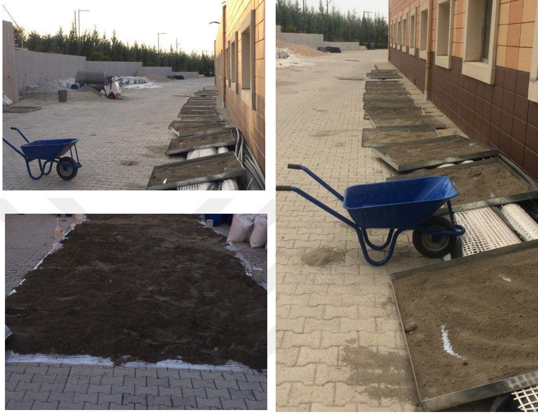
Şekil 3.4. Kum zemini kurutma işlemi
