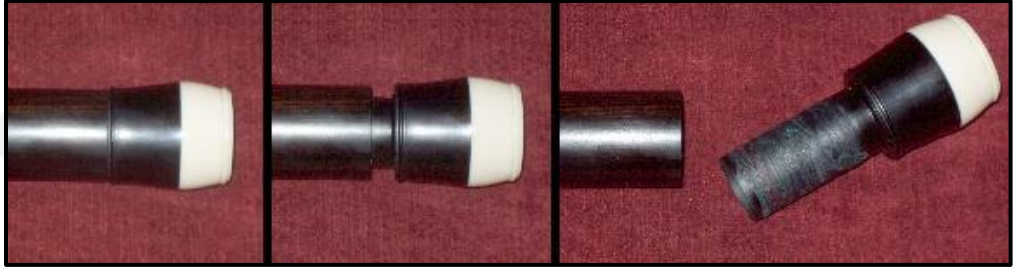
Şekil 13. Johann Joachim Quantz tarafından tasarlanmış ve yapılmış, flütün akort sorununun çözümü için düşündüğü ağızlık vidası
