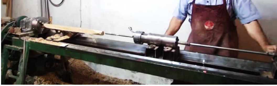
Resim 76. Tornaya bağı olan matkapla kavalın içinin açılması 163
