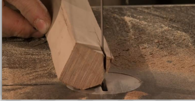
Resim 72. 4 x 4 cm ağacın köşelerinin kesilmesi 159
