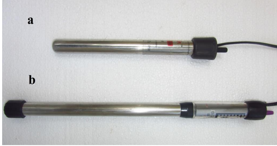
Şekil 3. 7. Denemede kullanılan 100 wattlık (a) ve 200 wattlık (b) çelik ısıtıcılar
