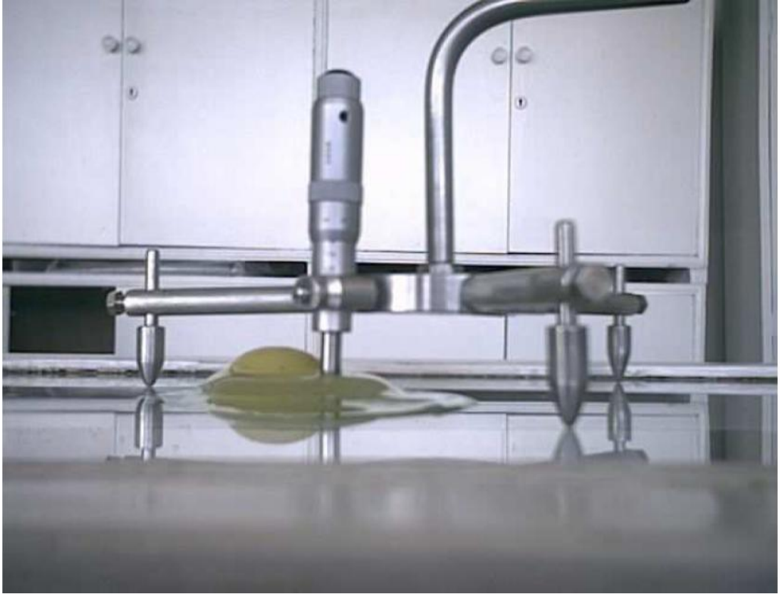
Şekil 3.8. Üç ayaklı mikrometre
