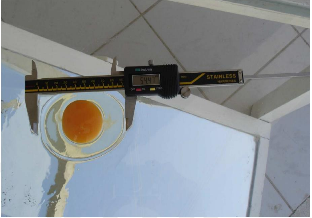
Şekil 3.7. Dijital kumpas ile ak indeksinin belirlenmesi
