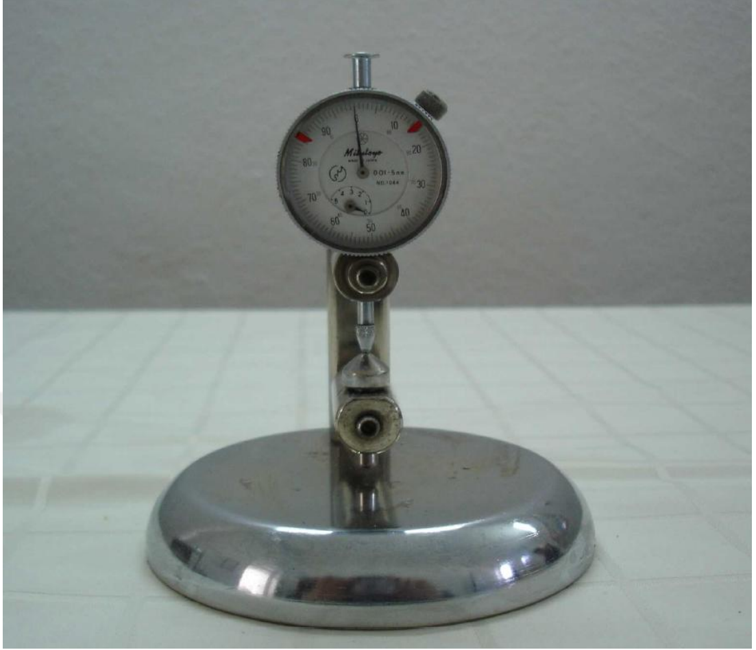
Şekil 3.6. Kabuk kalınlığı ölçüm aleti
