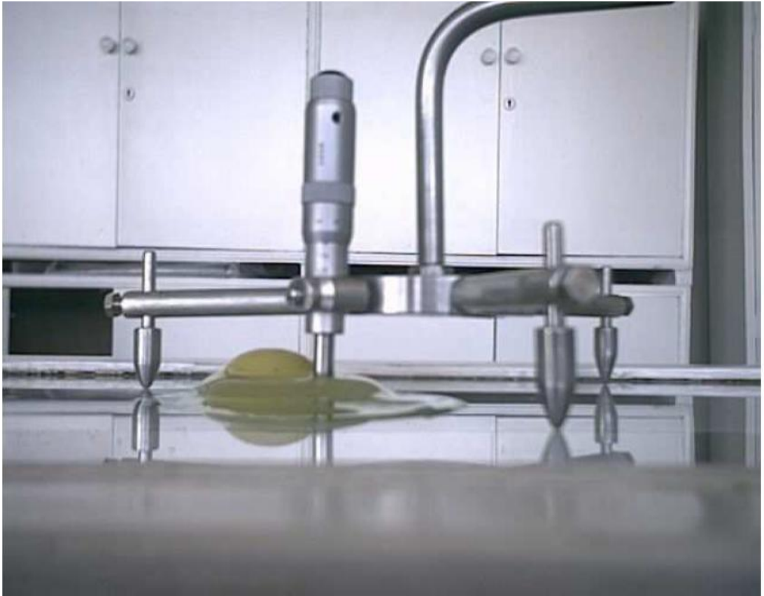
Şekil 3.8. Üç ayaklı mikrometre
