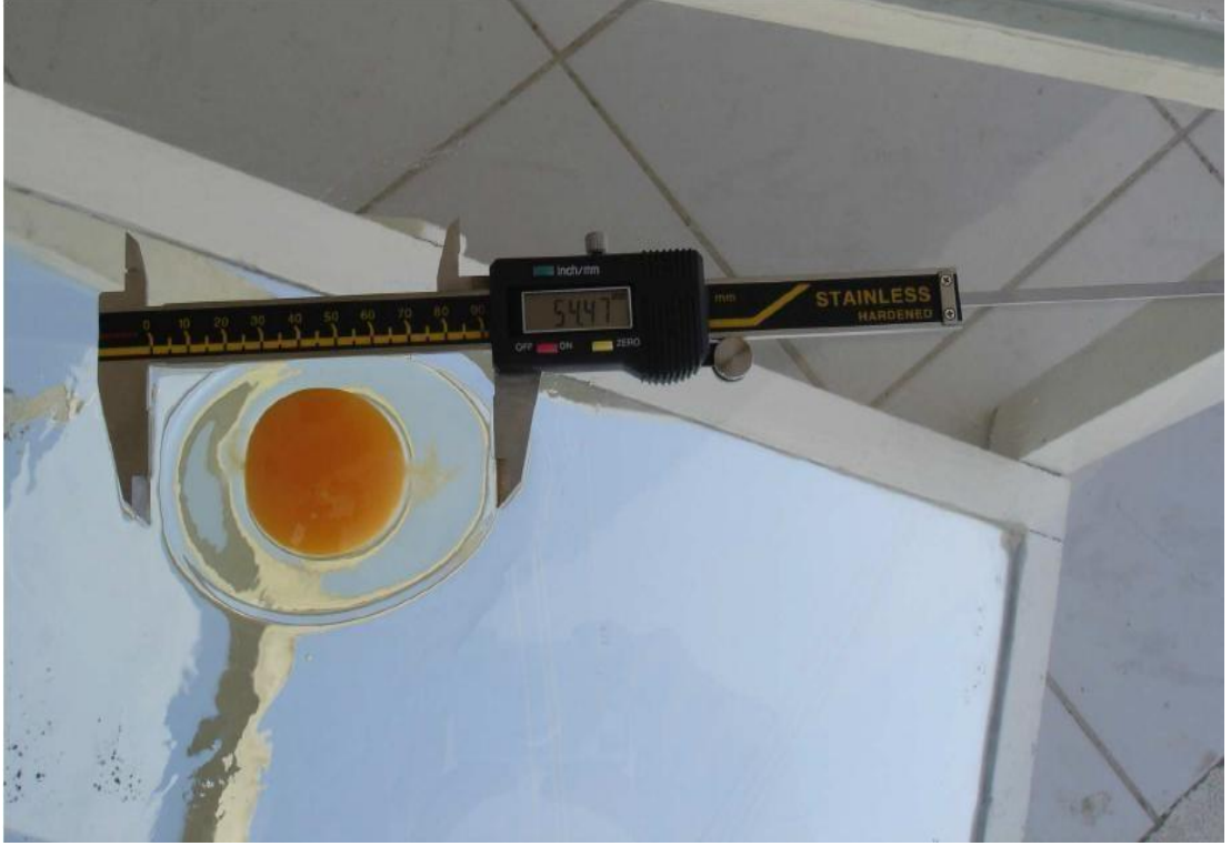
Şekil 3.7. Dijital kumpas ile ak indeksinin belirlenmesi
