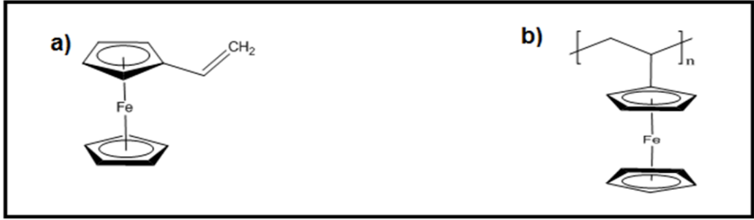
Şekil 3.5. a) Vinilferrosen ve b) poli(vinilferrosen)'in kimyasal yapısı.
