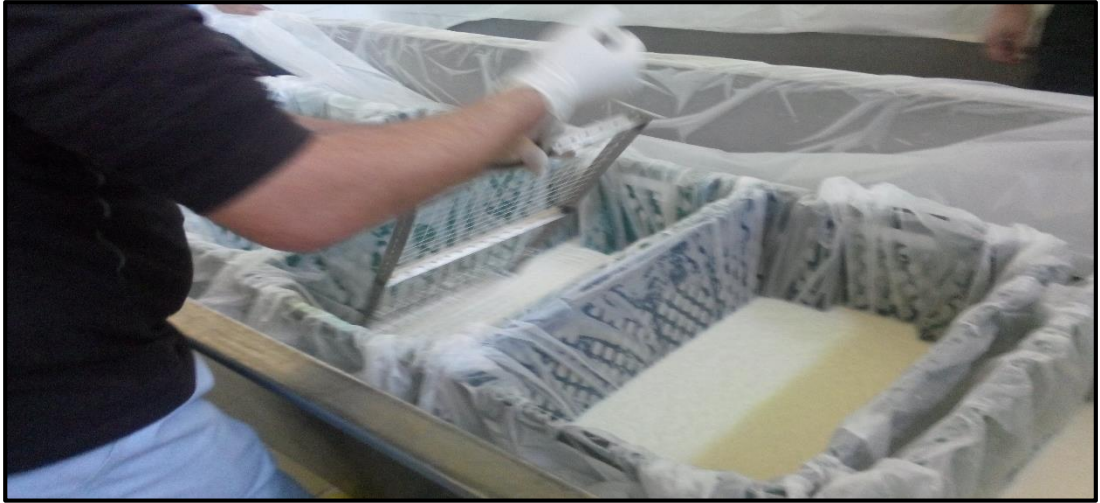
Şekil 3.2. Pıhtının pıhtı işleme bıçağı ile uygun şekilde parçalanması
