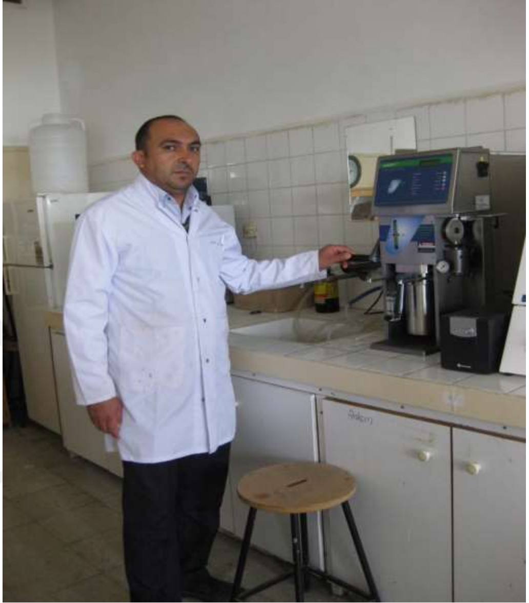
EK 8. Ekstraktların Hazırlandığı Ancom Extractor
