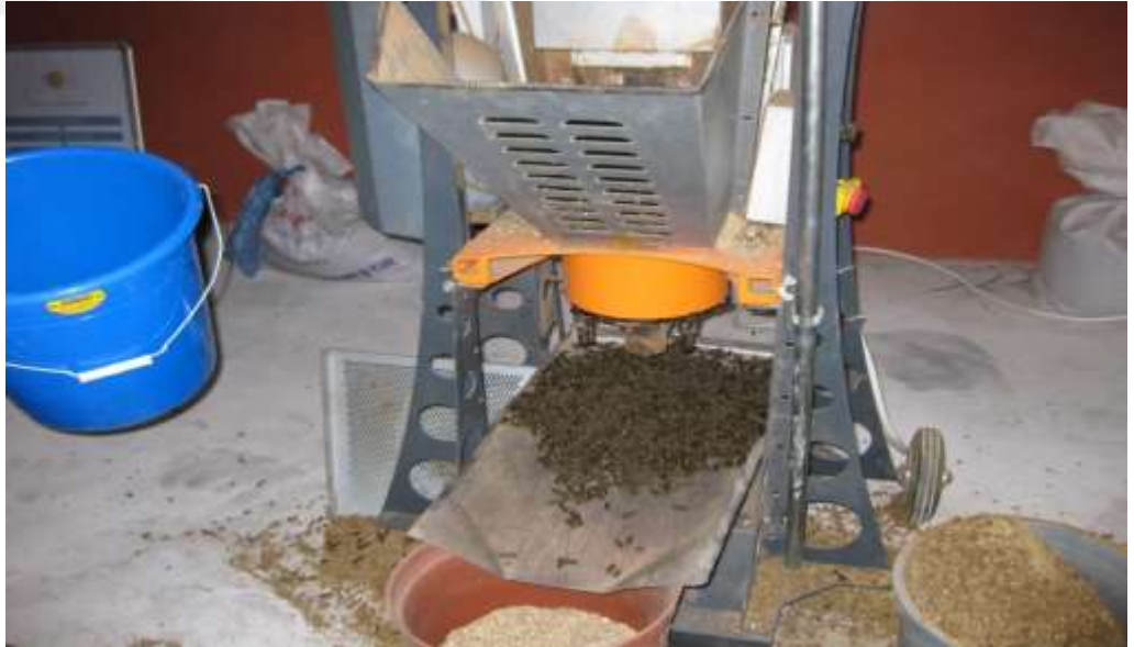
EK 6. Pelet yapım makinesinden çıkmış peletler
