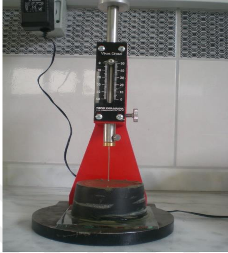
Şekil 4.9. Çimento priz süresi deney anından bir görünüm
