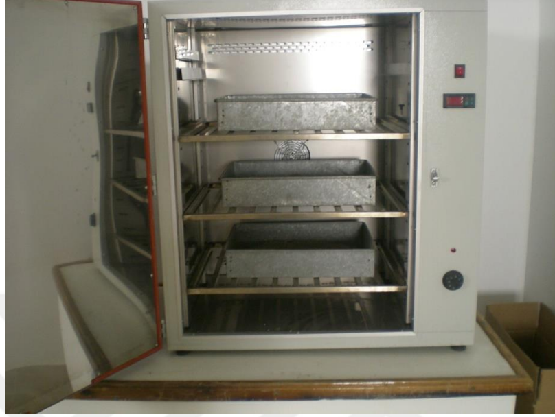
Şekil 3.4. Agreg a numunelerinin etüvde kurutulması
