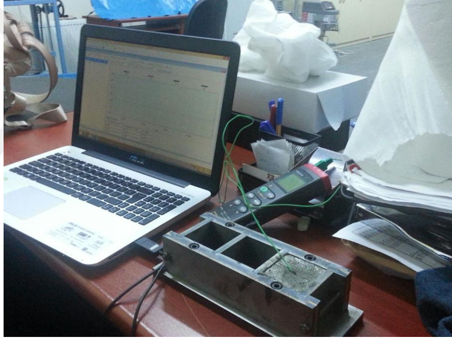
Şekil 3.8. Çimento harç numunelerinin datalogger ile sıcaklık ölçümleri
