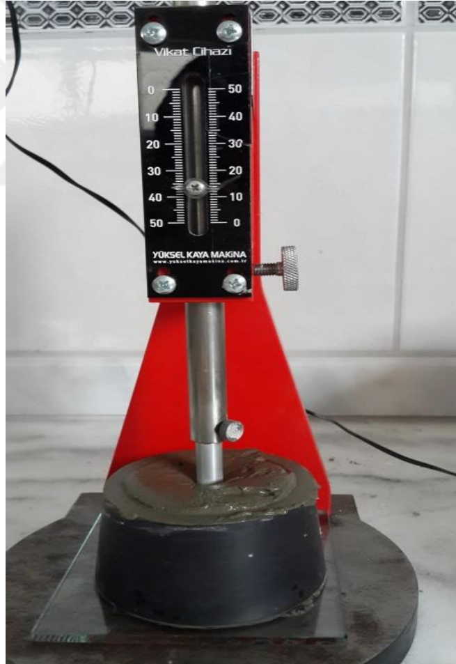
Şekil 4.8. Çimento kıvam deney anından bir görünüm
