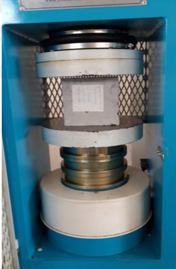
Şekil 4.23. Sertleşmiş beton numunesinin basınç dayanımı deney anından görünüm
