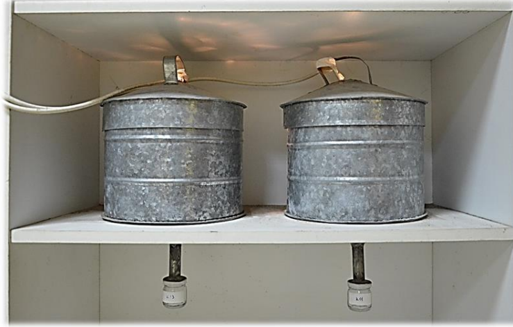
Şekil 3.23. Akar ekstraksiyonunda kullanılan berlese hunisi
